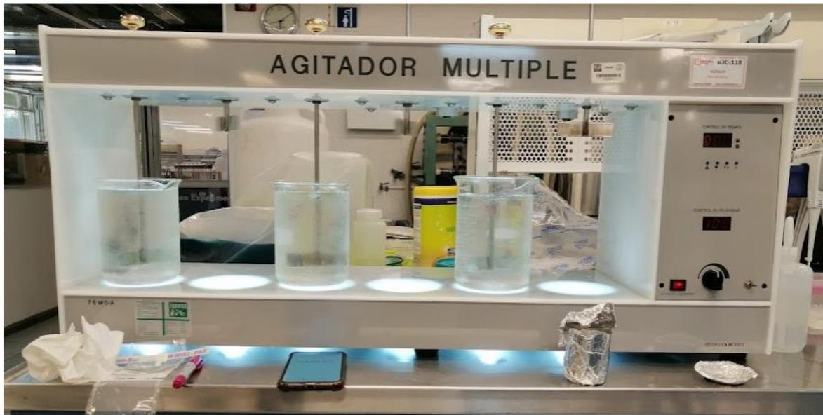
Figura 3. 19. Prueba de desinfección simulada en lote a través del sistema de jarras para la PPRM1
