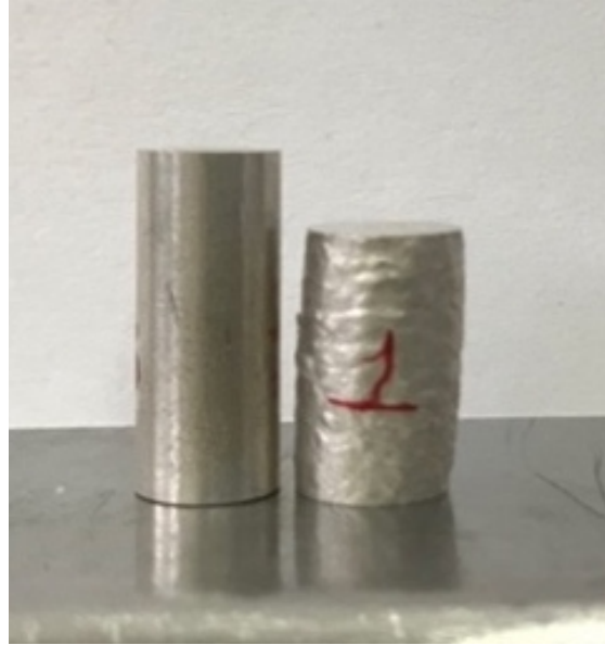
Figura 23. Probeta de Mg_{98}Zn_{0.5}Ag_{1.5} antes (izquierda) y después (derecha) del ensayo de compresión
