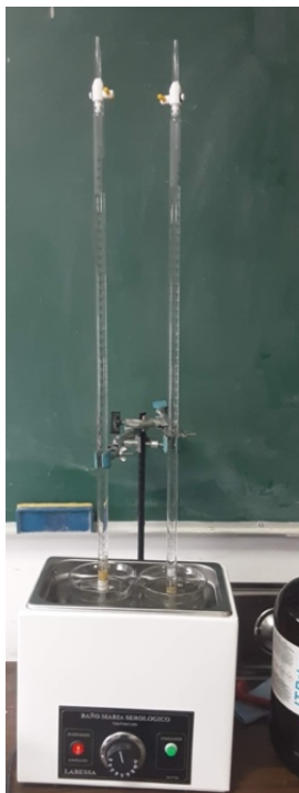
Figura 12. Ensayo de inmersión bajo condiciones fisiológicas simuladas.
