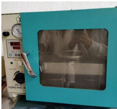
Imagen 3. Secado de muestra en horno a 100 °C
