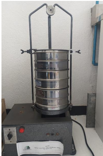
Imagen 7. Columna de tamices con la muestra de arena acoplada en el ROTAP.
