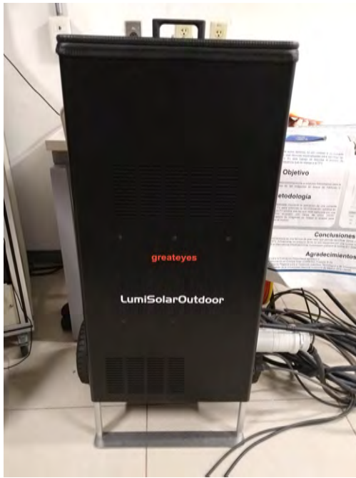
(a) Fuente de corriente de electroluminiscencia
