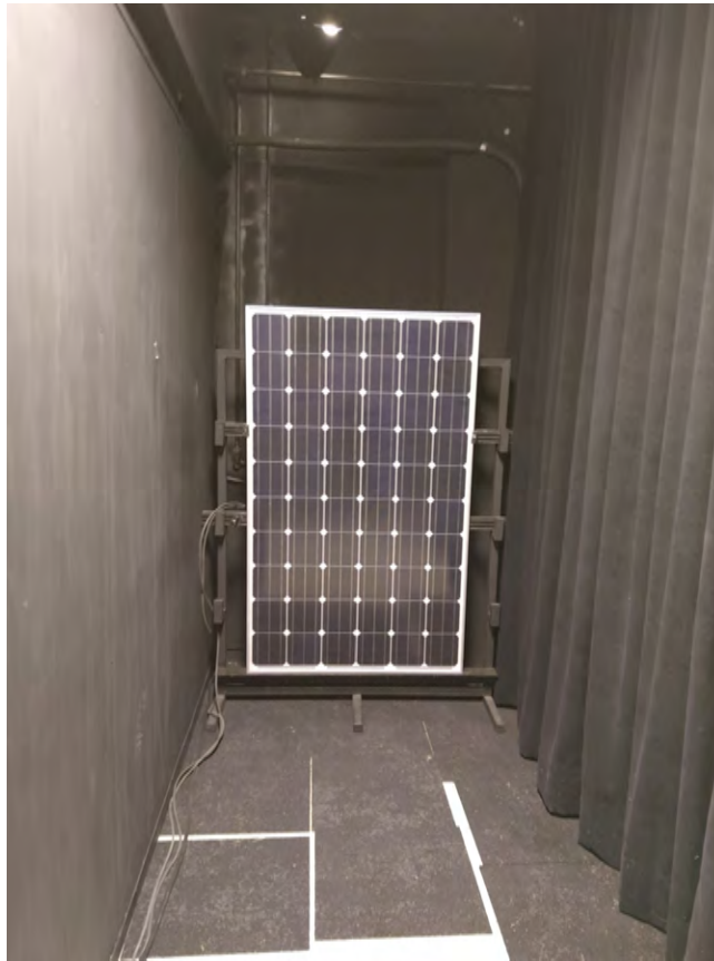
Figura 46: MFV sobre soporte en cuarto de electroluminiscencia
