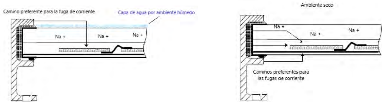
(a) Fenómeno del PID en MFV tipo-P con un ambiente húmedo
