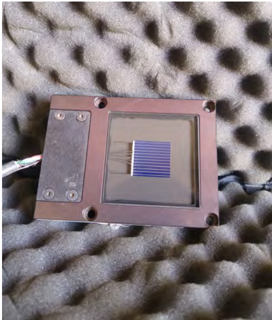
(a) Celda de referencia para procedimientos de caracterización
