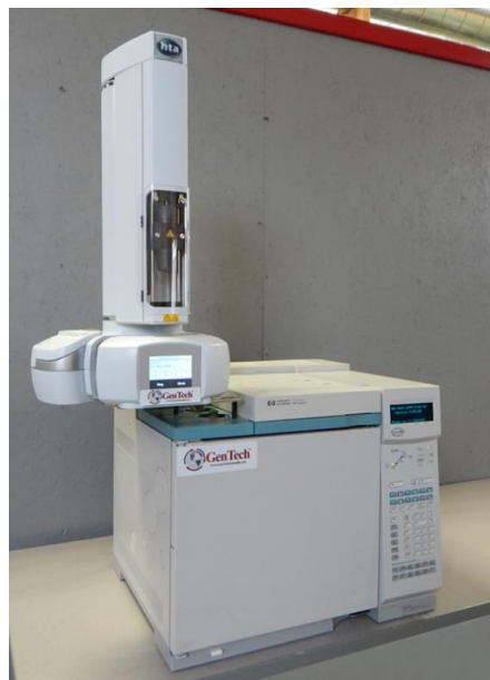
Figura 14. Ejemplo de cromatógrafo de gases HP 6890 N (Fuente: https://gentechscientific.com/agilent-gc-systems/770-agilent-6890n-headspace.html ).
