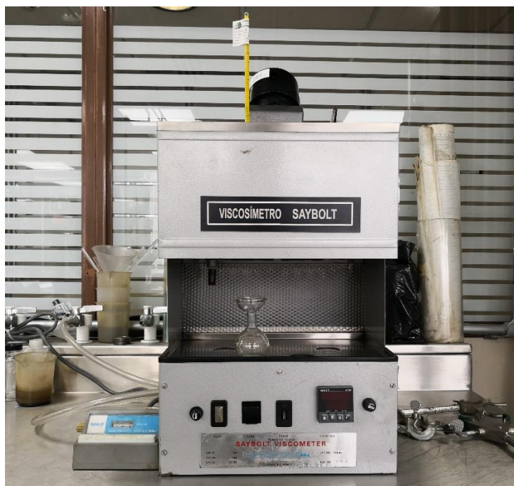
Figura 10. Fotografía del viscosímetro Saybolt utilizado para esta investigación.
