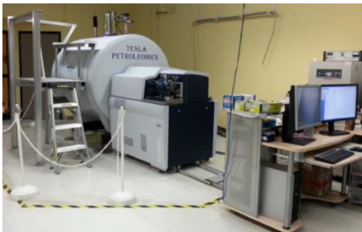
Figura 17. Espectrómetro de masas de resonancia ion-ciclotrón con transformada de Fourier (Equipo Bruker 12 Tesla Solarix FTICR-MS), de la Universidad de Calgary.
