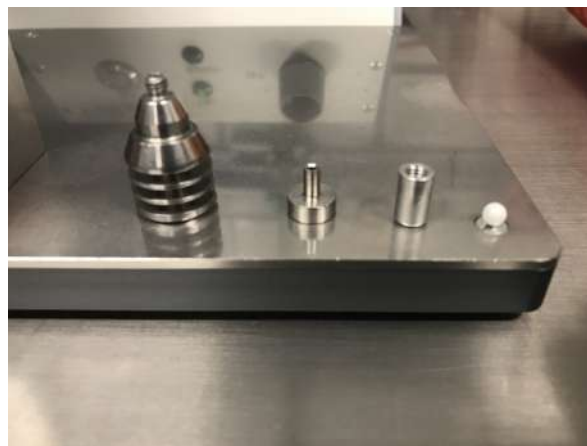
Figura 3.2: Imagen del cátodo, el portacátodo y la compresora. El cátodo es el cilindro pequeño.
