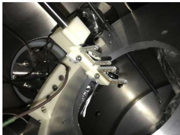
(b) Montura dentro de la cámara de reacción
