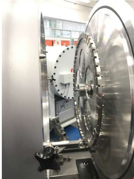
Figura 3.4: Imagen del carrusel que es donde se insertan los cátodos para producir los haces de nuestro interés.
