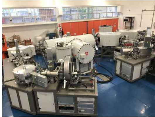
(b) LEMA, acelerador tipo tandem modelo 4110Bo-AMS HVEE de 1 MV. Instalado en el año 2013 y nombrado Laboratorio Nacional en 2014.
