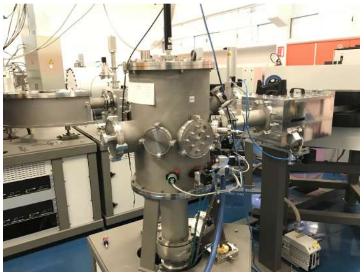
Figura 3.8: Cámara de reacciones y un lado está el imán de alta energía
