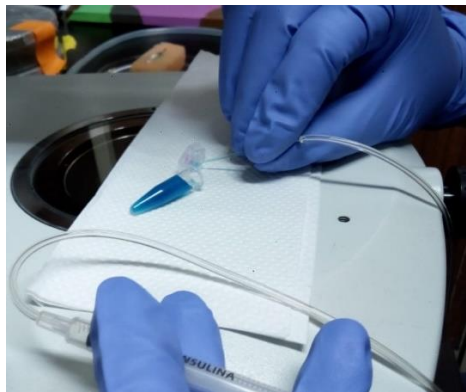
Figura 16. Proceso de carga de muestra. Para obtener la muestra se dejó un volumen de aire en la jeringa, posteriormente se acercó la punta del capilar a la gota de solución y se fue jalando el émbolo de la jeringa muy lentamente hasta que el volumen de la gota se cargó por completo y de manera uniforme. Para verificar que no hay residuos de solución en la tapa se utilizó la luz del microscopio.
