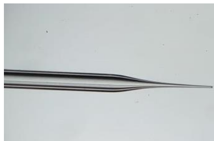
Figura 8. Microscopía de la punta del capilar cortado (aguja), abierto y con el bisel del tamaño adecuado para realizar la punción.
