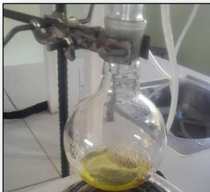
**Ilustración 21. Obtención de grasas y aceites al término de la extracción**
