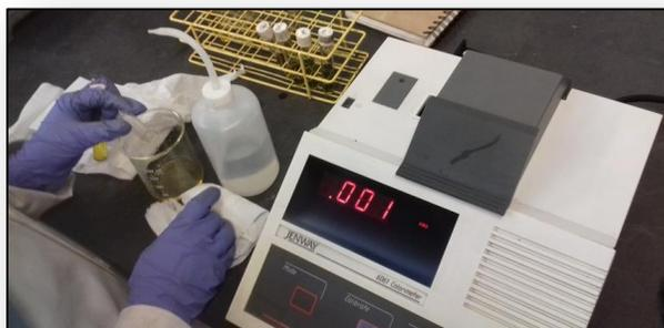
**Ilustración 19. Cálculo de la absorbancia en el espectrofotómetro**
