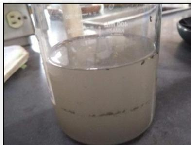
**Ilustración 22. Identificación de color en muestra de agua**
