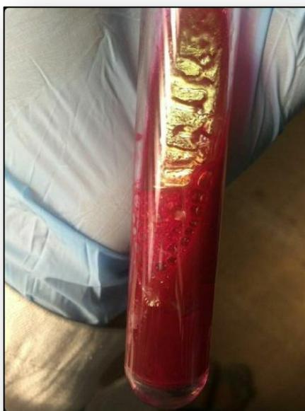
**Ilustración 16. Identificación de presencia de organismos coliformes en los tubos**
