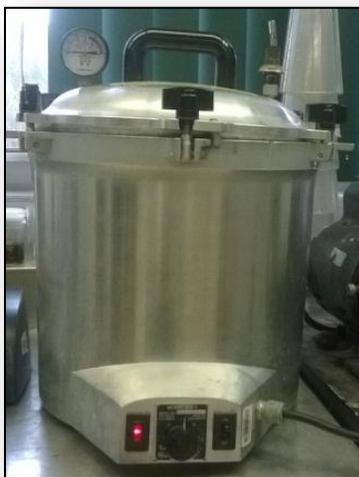
**Ilustración 3. Autoclave**
