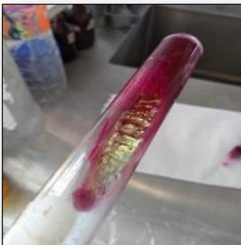
**Ilustración 15. Identificación de presencia de organismos coliformes en los tubos**
