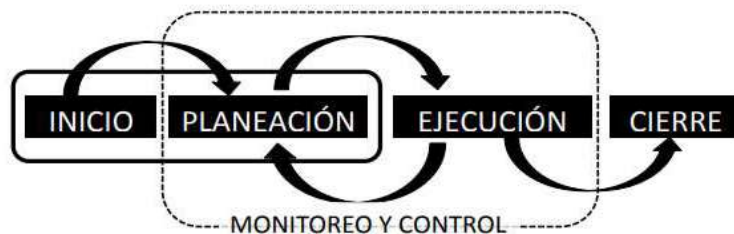
Figura 3.1 Los cinco procesos de la administración de un proyecto. Fuente: Adaptado de la Guía del Project Management Body of Knowledge, PMBOK Guide (2009)
