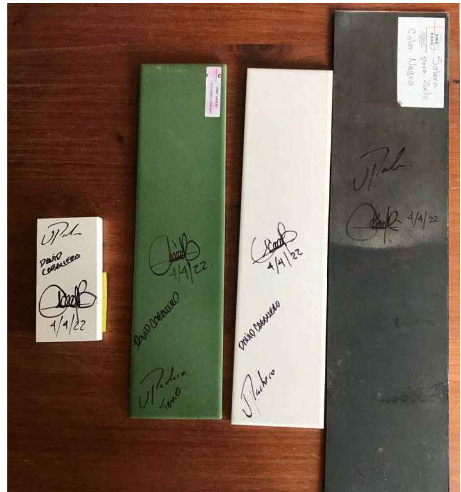
Figura 5.10 Firma de acabados por equipo de obra y equipo de arquitecto proyectista.
