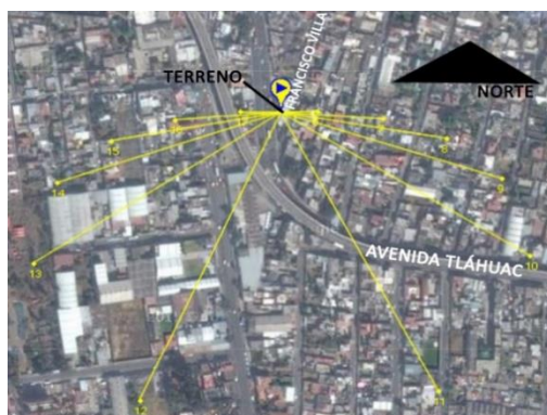
Figura 3. Ángulos de incidencia solar de las 06:00 a las 17:00 horas. Obtenida de: http://www.sunearthtools.com/ (año 2016).
