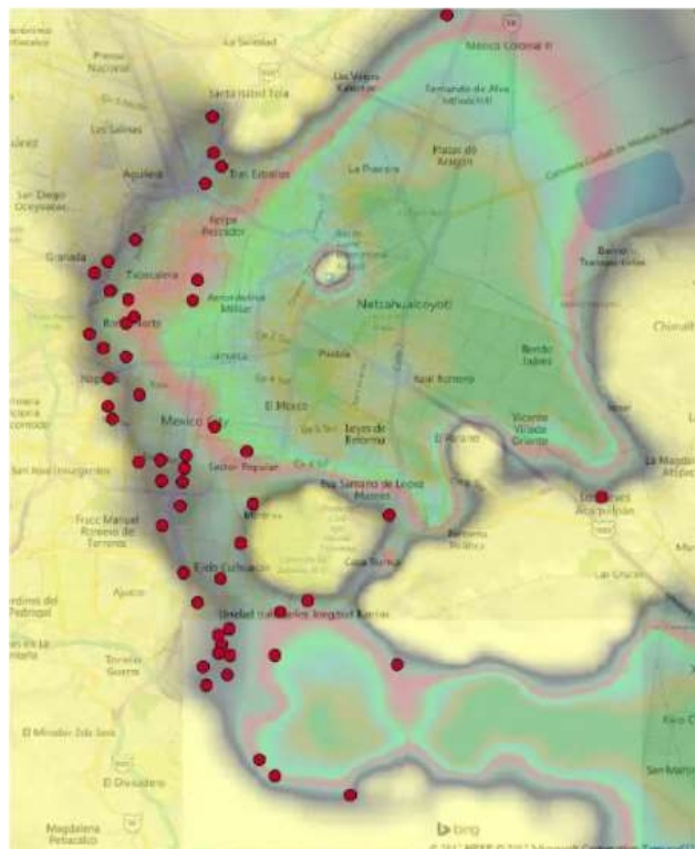
Figura 4.7 Localización de edificios colapsados en la Ciudad de México durante el sismo de 2017 (ERN, 2017).
