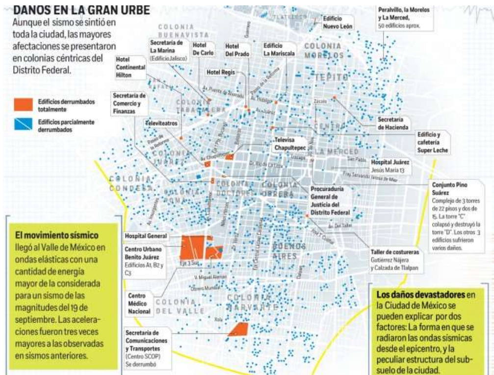
Figura 4.5 Distribución espacial de edificios colapsados en Ciudad de México debido a los sismos de 1985 (Páramo, 2015).
