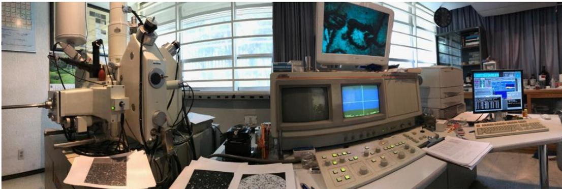
Fig. 8. Observación de láminas delgadas pulidas recubiertas en la Microsonda Electrónica de Barrido (EPMA) del Instituto de Geofísica.
