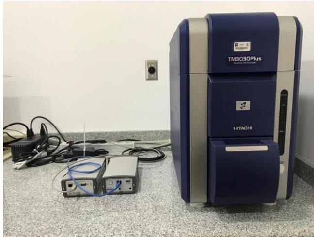
Fig. 9. Microscopio Electrónico de Barrido SEM-EDS Hitachi TM3030 Plus.
