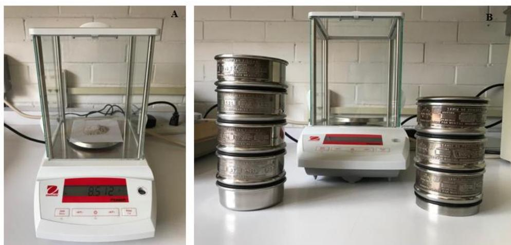
Fig. 6. (A) Pesado de la muestra previo al tamizado. (B) Tamices empleados para la distribución de tamaño de grano.
