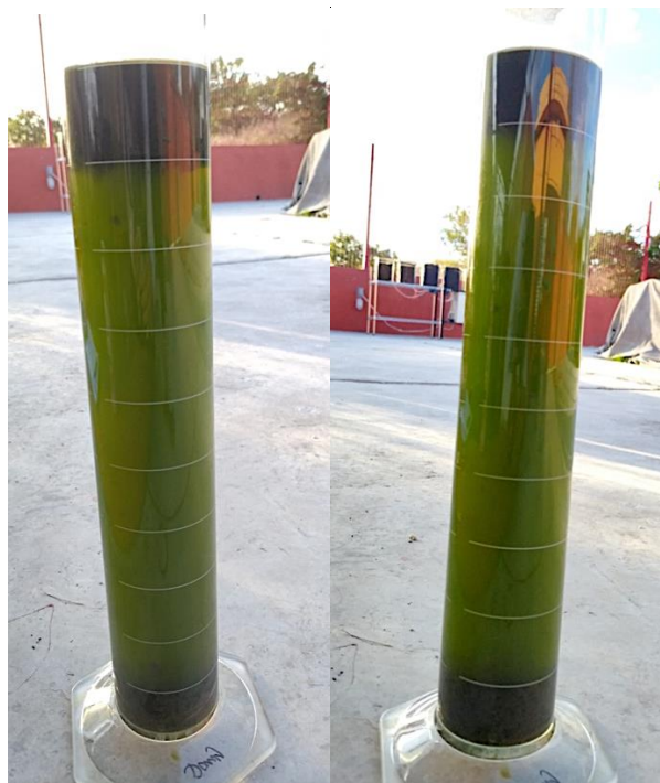
Figura 23. Sedimentación a 61 días de operación. Izquierda reactor 1 y derecha reactor 2.
