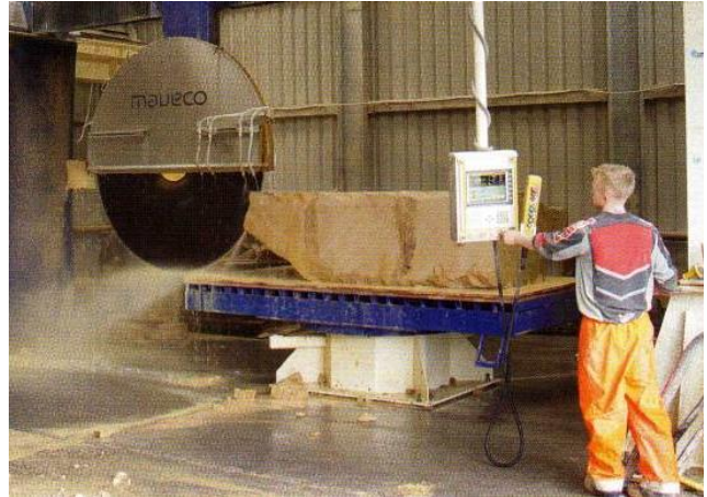
Ilustración 19 Máquina de corte marca Maveco, de la empresa Británica "Doultling" imagen tomada de la revista: "Natural Stone Specialist" Tomo: Sept 2008 pg 66 reproducción hecha con fines didácticos
