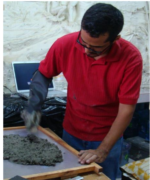
Ilustración 38 Vaciado de la mezcla en el molde
