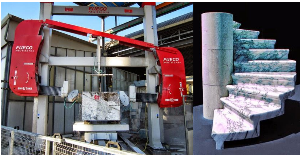
Ilustración 41: Izq. Máquina de corte con hilo de diamante de 10 ejes con control numérico. Der. Escalera helicoidal manufacturada en 1 sola pieza. Foto: Breton stone machinery Reproducción con fines didácticos
