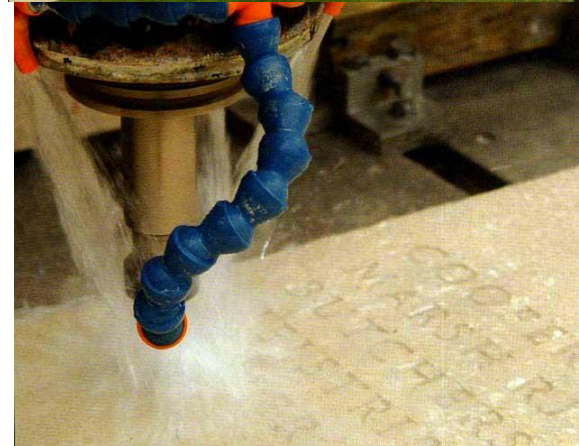
Ilustración 20 Máquina de grabado con punta de diamante, controlada por computadora grabo enlozas curvas de piedra portland, los más de 15,000 nombres del monumento de las fuerzas armadas (Inglaterra) Imágenes tomadas de la revista: "Natural Stone Specialist" Tomo: dec 2008 pg 34
