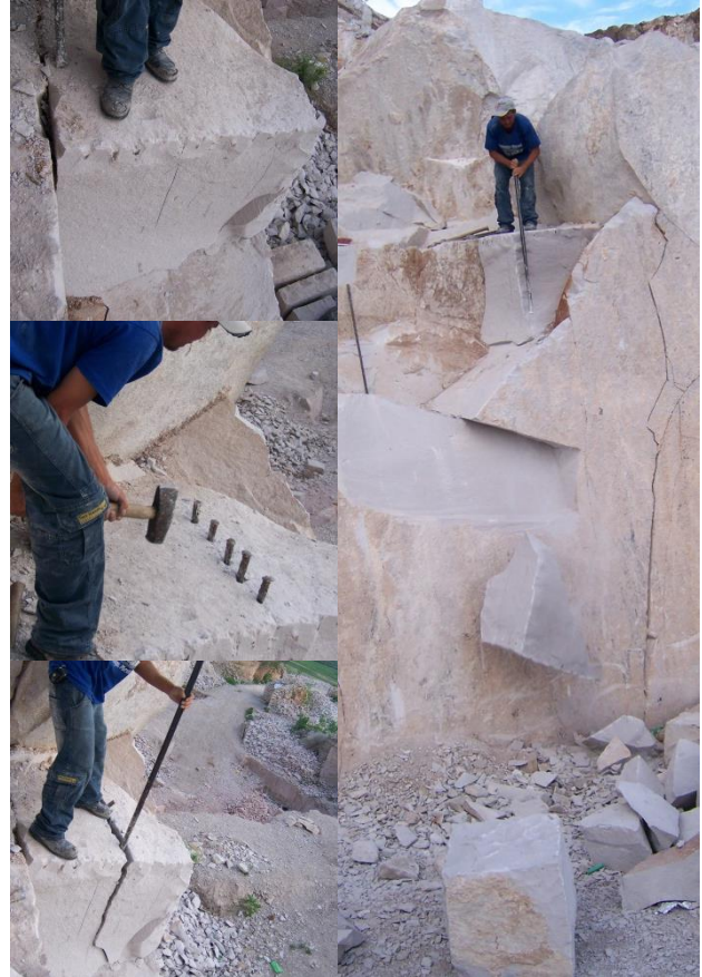
Ilustración 40: Algunas imágenes del banco de cantera del poblado "Garabitos" Izq arriba: se utilizan las grietas naturales de la roca para separarla por medio de barras. Izq Central: también se pueden usar cuñas para fracturar manualmente la piedra en secciones menores Izq. Abajo: la piedra es separada una vez aparece la fractura. Der.: La roca cae sobre llantas ramas o colchones de grava para evitar su ruptura, después es trabajada a tamaños regulares para su venta
