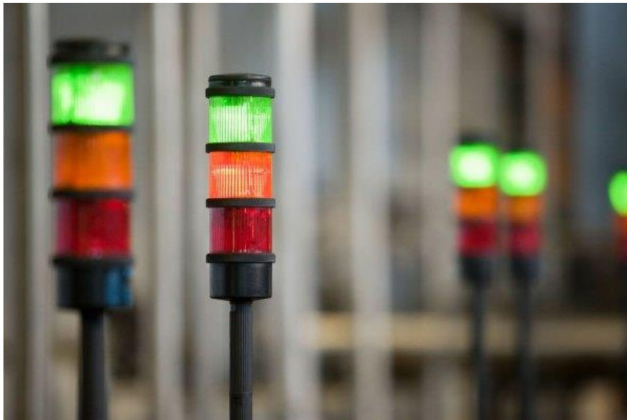
Ilustración 18. Torreta de sistema andon
