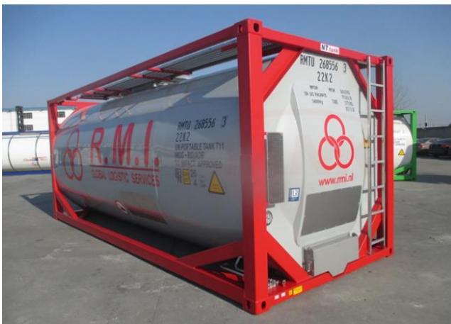
Imagen 18. Contenedor de Tanque de Cloro (NT Tank, s.f.).
