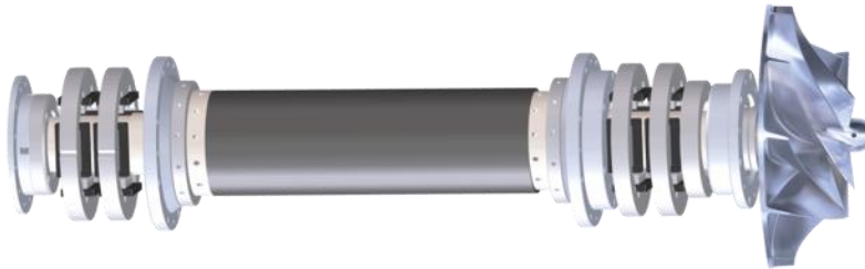
Imagen 3-8. Soplador con rodamientos magnéticos. 48
