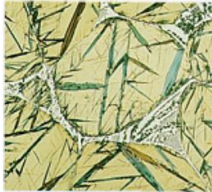
Fig. 33 Micrografía de un acero con 1.86%wt C atacado con nital al 2% para revelar agujas martensíticas con granos de austenita y ledeburita en las fronteras de grano. Fotografía a x500 (11).
