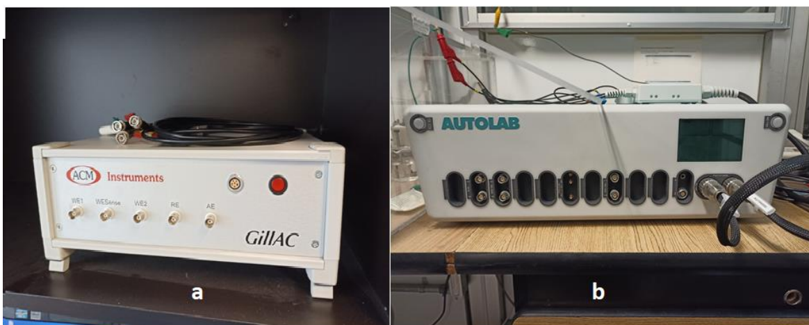
Fig. 28 a) Potenciostatos GillAC ACM Instruments utilizado para la técnica de Ruido Electroquímico, b) Autolab utilizado para realizar la técnica de Impedancia Electroquímica.
