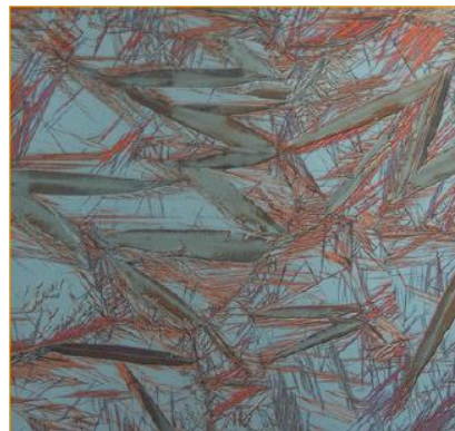
Fig. 10 Microestructura de la martensita, la forma acicular de los granos orientada sin dirección preferente (6)
