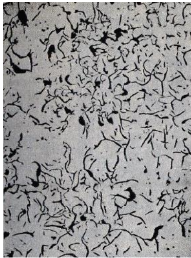
Fig. 20 Microestructura del hierro gris (5).
