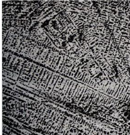
Fig. 18 Microestructura de un Hierro blanco a 20x (5).
