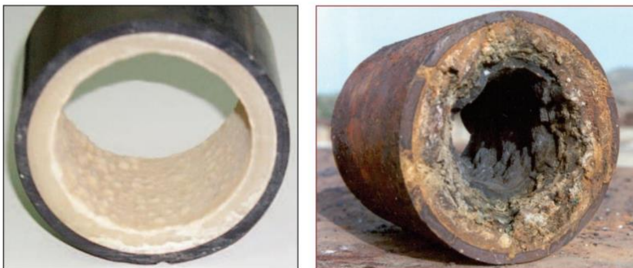
Figura 76. Incrustación en tuberías geotérmicas. A la izquierda, precipitados de \text{CaCO}_3 en una tubería que transporta agua geotérmica de baja entalpía en Nigrita, Grecia. A la derecha, precipitados mixtos de sílice y sulfuro en tuberías de reinyección de la planta geotérmica de Milos, Grecia (Andritos, Karabelas, & Koutsoukos, 2002).
