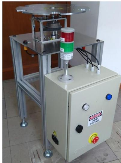
Fig. 4.8 Manufactura y ensamble de mesa indexada
