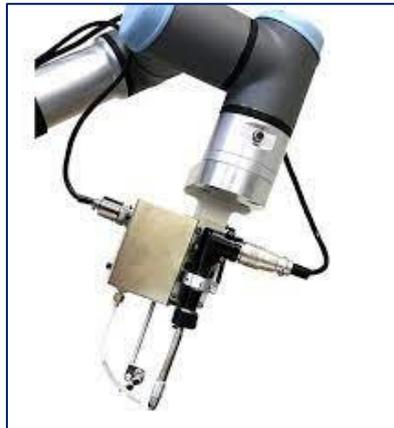
*Fig. 2.9 Efector final para soldadura <sup>(33)</sup>*
