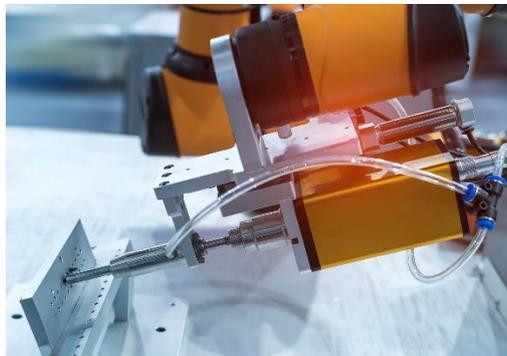
*Fig. 2.10 Efector final para fresar <sup>(35)</sup>*
