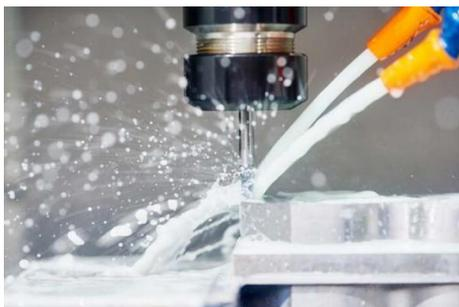
Fig. 4.16 Mecanizado CNC del aluminio para cambio rápido
