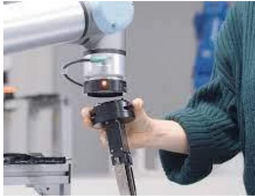
Fig. 2.14 Efector final para cambio rápido de herramienta<sup>(36)</sup>
