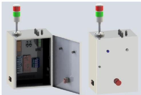
*Fig. 4.5 Conjunto de sistema eléctrico-electrónico de la mesa indexada*
