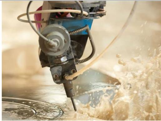
Fig. 2.11 Efecto final para corte de agua con abrasivo <sup>(35)</sup>
