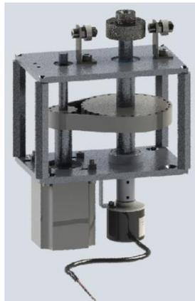
*Fig. 4.4 Transmisión mecánica*
