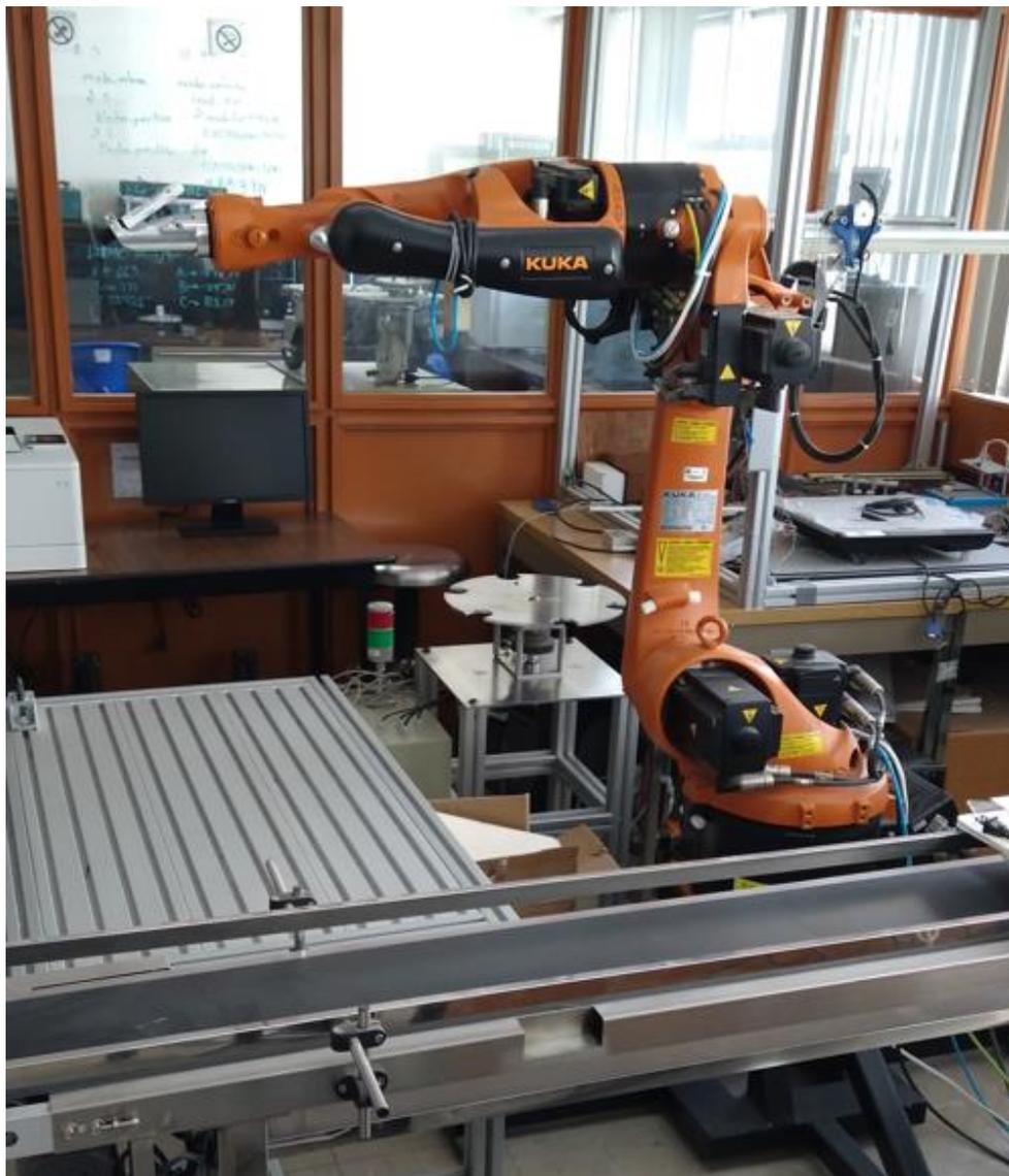
*Fig. 4.9 Implementación de la mesa indexada a la celda de manufactura*
