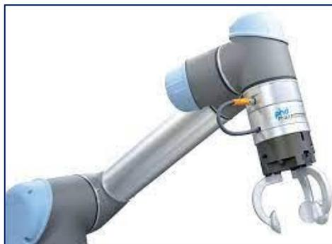
Fig. 2.12 Efecto final para manipulación <sup>(33)</sup>
