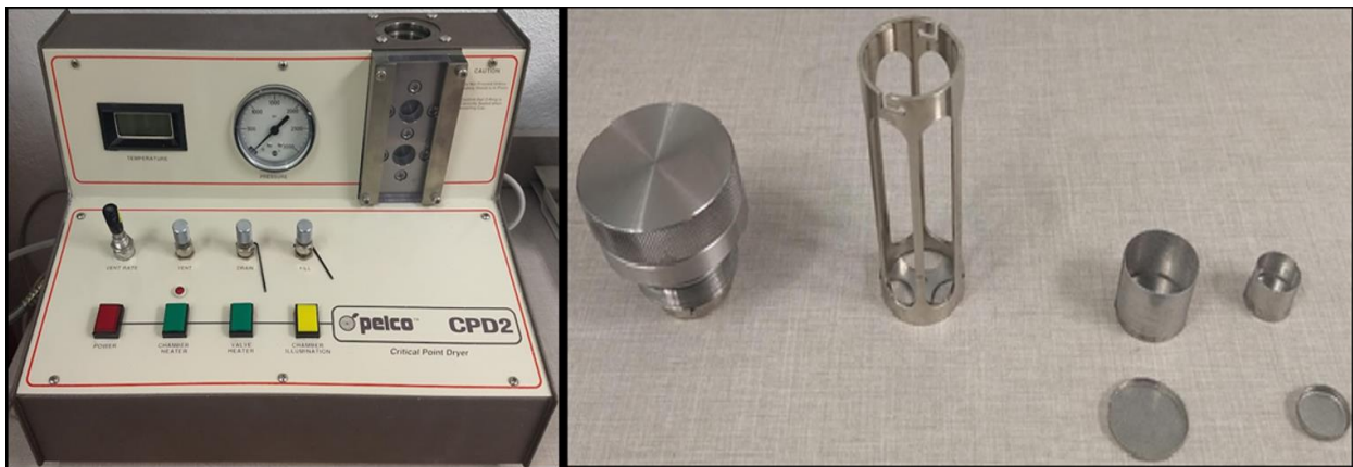
Figura 18: (Izquierda) Equipo de secado por punto crítico ubicado en el Laboratorio de Microscopía del CFATA. (Derecha) Portamuestras del equipo.
