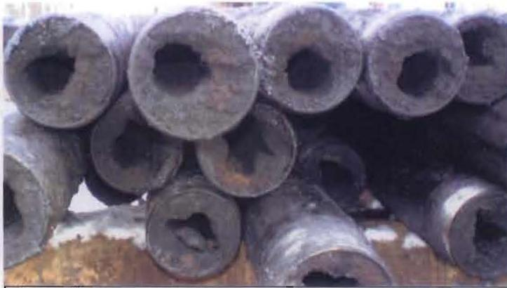
Figura 11. Taponamiento de asfaltenos en tuberías
