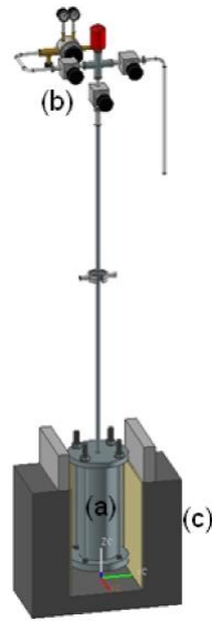
Figura 1.10. Sistema para el proceso de fabricación de las espumas de aluminio por infiltración, a) crisol, b) sistema de válvulas para la aplicación de vacío e inyección del gas, c) horno eléctrico [25].
