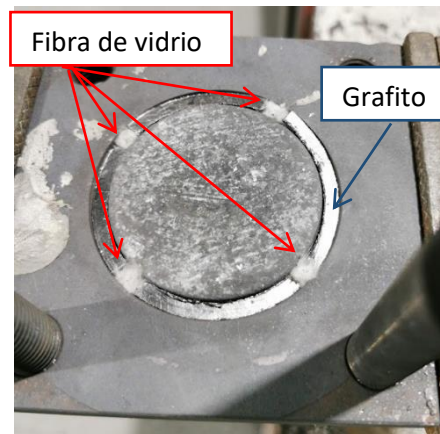
Figura 2.4. Plato inferior. Con las flechas rojas se señalan los espacios donde se posiciono la fibra de vidrio y la flecha azul señala el grafito.
