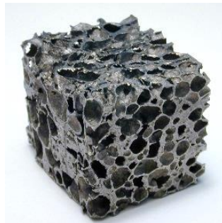
Figura 1.5. Espuma de aluminio de celda semiabierta [19].
