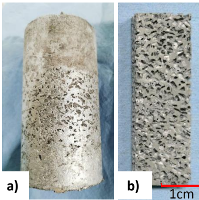
Figura 3.2. Espuma metálica de Al tamaño de poro de 2.36 mm, a) espuma obtenida de fundición, b) núcleo obtenido de seccionar la espuma de Al.
