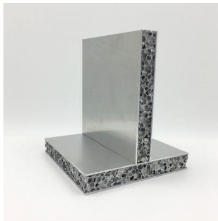
Figura 1.13. Estructura tipo sándwich con núcleo y revestimiento de aluminio [26].
