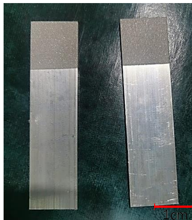
Figura 2.12. Arenado de las láminas empleadas para probetas del ensayo de adhesión.
