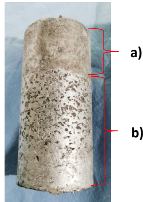
Figura 2.8. Obtención de la espuma metálica de aluminio, a) remanente de la fundición y rechupe, b) infiltración del aluminio (espuma metálica).
