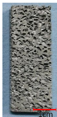
Figura 2.10. Pieza después del arenado con rugosidad uniforme, poro 2.36 mm.
