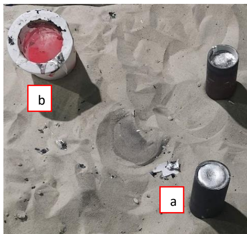
Figura 2.2. a) Lingote cilíndrico de Al 1100, b) Crisol de grafito con Al líquido.
