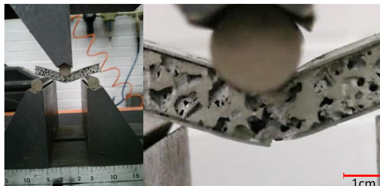
Figura 2.18. Falla de la espuma de Al con tamaño de poro de 2.36 mm en el ensayo de flexión en 3 puntos.
