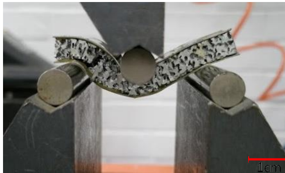
Figura 3.12. Falla por cizalladura en el ensayo de flexión en tres puntos aplicado en el PSA 2.
