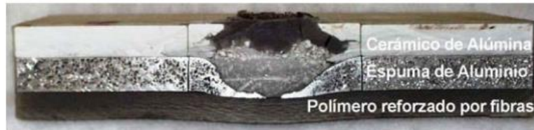
Figura 1.17. Blindaje híbrido con espuma metálica (aluminum foam) para vehículo militar [31].
