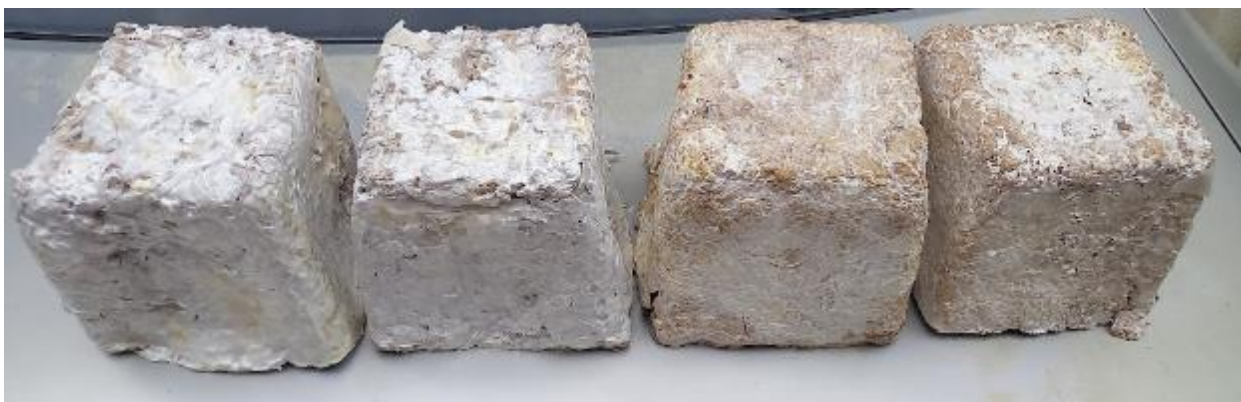
Ilustración 49. Prototipos (casetones) fabricados de 15x15x15 cm. los primeros dos de la izquierda fueron fabricados de cartón en trozos con micelio, los dos restantes corresponden a la mezcla de cartón machacado y micelio.
