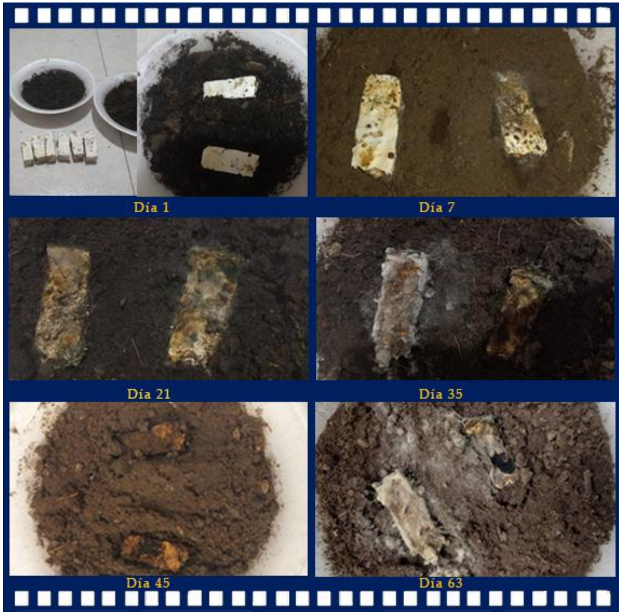
Ilustración 44. Proceso de biodegradación en 63 días.
