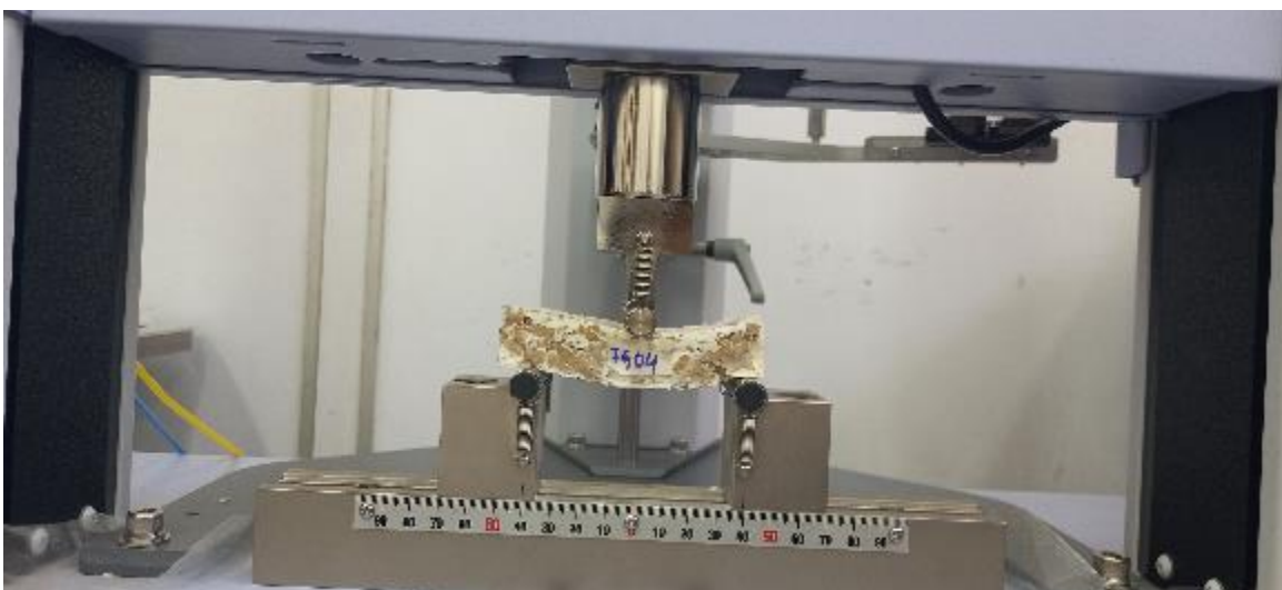
Ilustración 38. Prueba de flexión en 3 puntos con un espécimen del grupo FG0.
