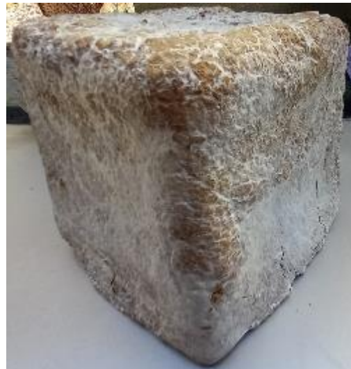
Ilustración 24. Prototipo final obtenido con cartón machacado y micelio.
