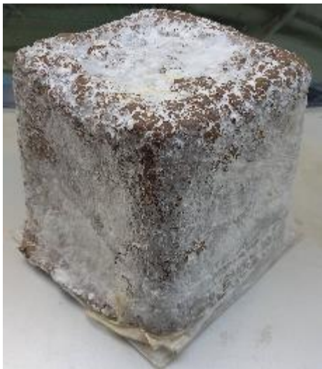
Ilustración 23. Prototipo final obtenido con cartón machacado y micelio.
