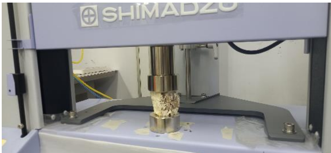
Ilustración 37. Espécimen de prueba a compresión del grupo CG1.
