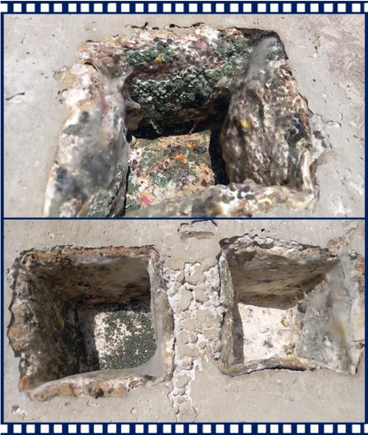
Ilustración 53. Reactivación e invasión de agentes externos al prototipo.
