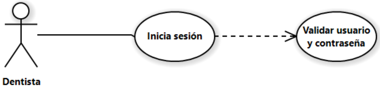
Figura 2. El caso de uso validar usuario y contraseña depende de que el dentista inicie sesión.
