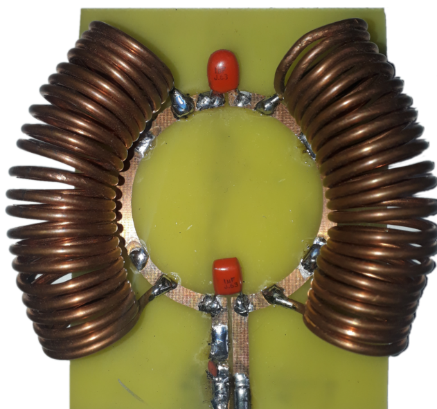
Figura C.6: Prototipo 11 de antena, para sintonizar a 128 MHz . Antena con circuito de sintonización y adaptación con las siguientes dimensiones: R_e = 2.5 cm , R_i = 2.2 cm y b = 0.3 cm , además se soldaron 2 inductores con 22 vueltas y un diámetro de 1.1 cm . Se midió el parámetro de dispersión S_{11} modificando la capacitancia de Tuning Antena, de Tuning y de Matching.
