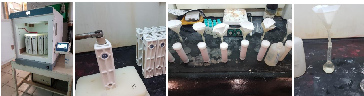
Figura 29. Fotografías del proceso de digestión de los plásticos seleccionados, de izquierda a derecha, horno de microondas, dispositivos para alta presión, tubos de teflón antes de verter el contenido, y matraz aforado de 50 mL con la digestión después de la filtración
