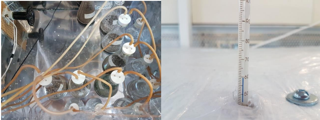
Figura 19. Fotografía izquierda, interior de la incubadora con los biorreactores conectados a la fuente de aire y a la derecha termómetro mostrando una temperatura de 59°C dentro de la incubadora
