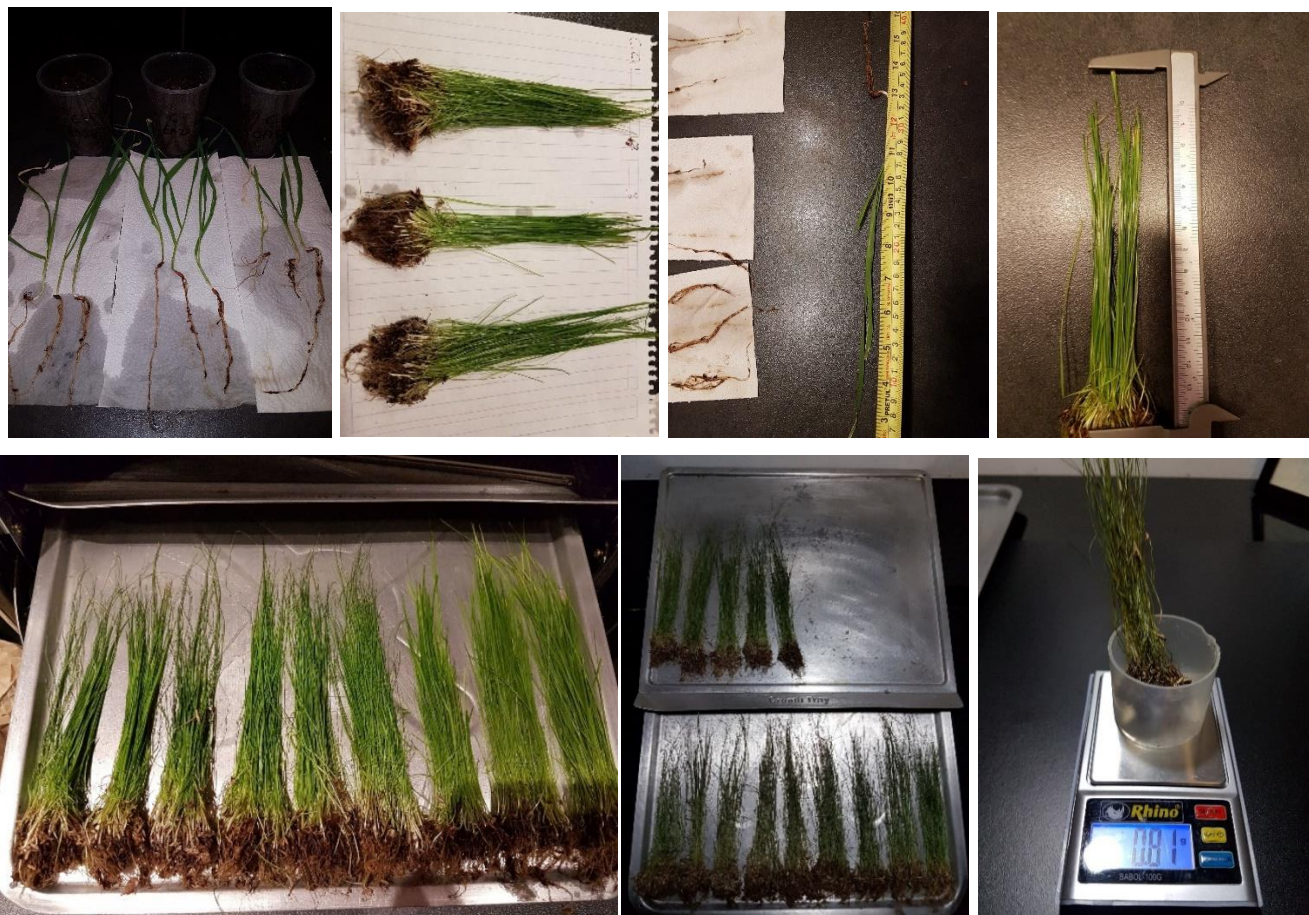
Figura 26. Fotografías del proceso de extracción procesamiento de las plantas, arriba de izquierda a derecha: 1 y 2) limpieza y secado de raíces, 3 y 4) medición de altura máxima, abajo de izquierda a derecha: 1) Colocación de pasto en charolas para secado en horno, 2) pasto seco después de 24 h en el horno y 3) pesaje de biomasa seca
