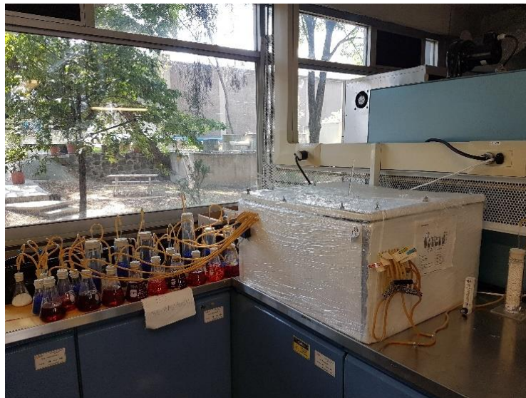
Figura 16. Imagen completa del sistema real montado para llevar a cabo la prueba de biodegradación por el método de análisis de dióxido de carbono desprendido
