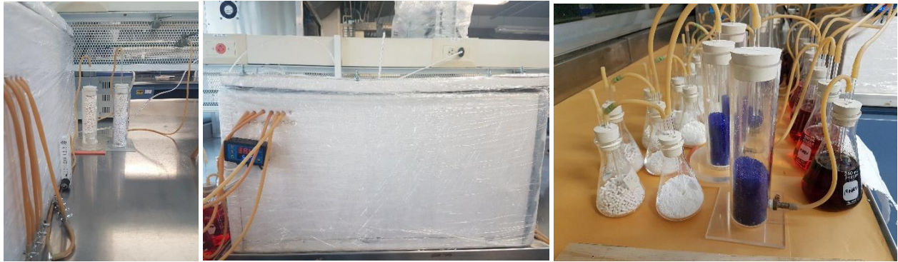
Figura 17. Imagen del sistema real una vez montado, a la izquierda se observa la conexión de aire con la trampa de CO 2 de ingreso, un flujómetro y llaves de paso para regular el flujo de aire, en el centro se puede observar la incubadora, y a la derecha se observan las trampas de amonio los deshumidificadores y la trampa de CO 2 final
