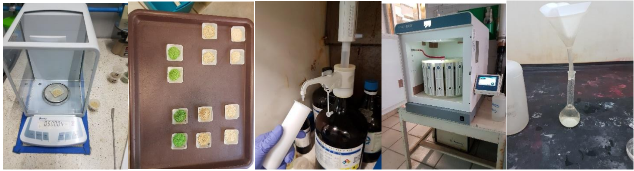
Figura 36. Fotografías del proceso de digestión de las heces de las larvas de T. molitor y Z. morio . De izquierda a derecha: 1) pesaje de una muestra, 2) muestras listas para la digestión, 3) adición de ácido nítrico 70% a un tubo de teflón con muestra, 4) Horno de microondas con muestras y 5) matraz aforado de 50 mL con el filtrado de la digestión
