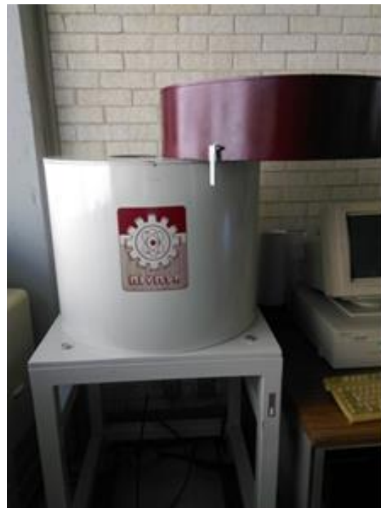
Figura 5. Espectrómetro de radiación gamma con detector de centelleo con blindaje de plomo y computadora (Facultad de Química).
