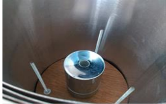
Figura 6. Área del Detector de centelleo (NaI(Tl))
