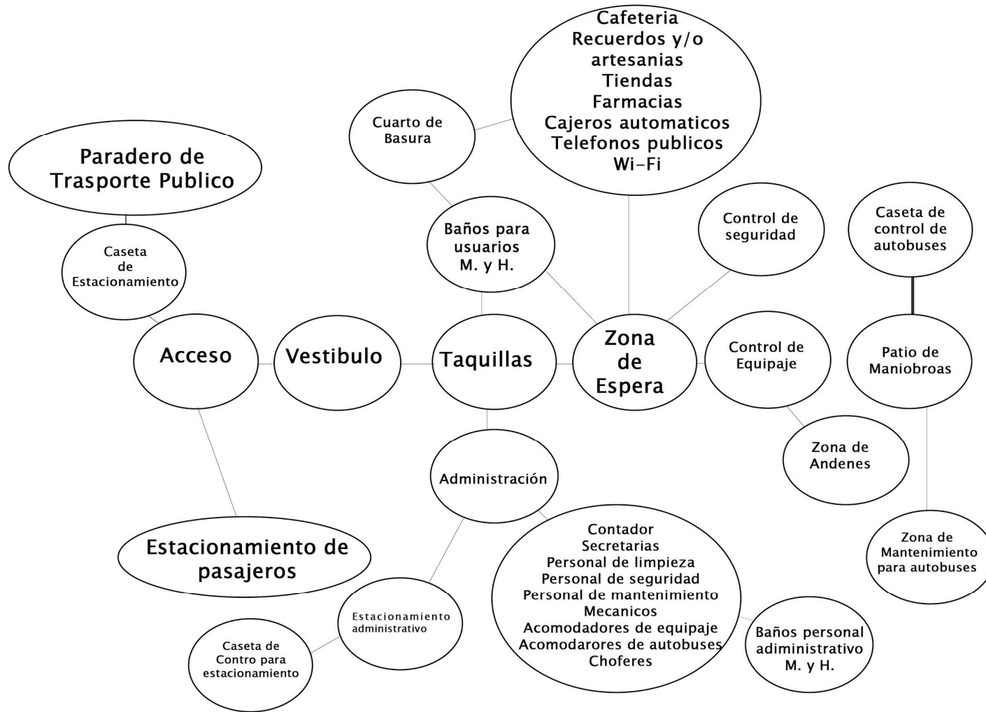
Imagen 65 Esquema de Funcionamiento para proyecto de la Central de Autobuses Tepoztlán.
