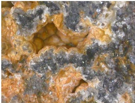
Fig. 48 (lupa, 10x). Asociación galena-mimetita, se observa claramente que el probable arseniato cristalizó sobre la galena (color oscuro).
