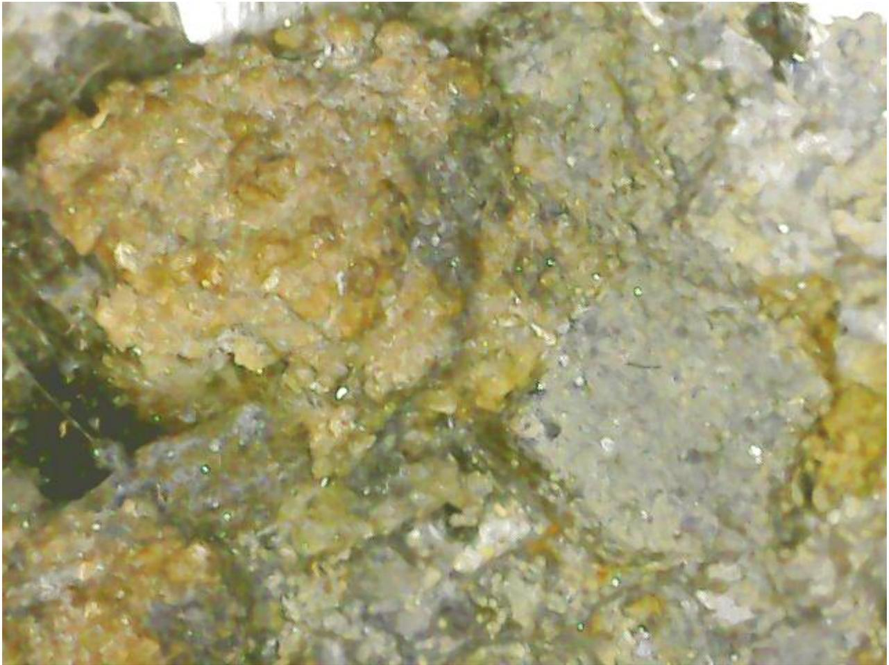
Fig. 61 (lupa, 10x). Cristales botroidales de calcita (imitando las formas de la pirita por cristalizar encima) impregnada de óxidos de hierro.
