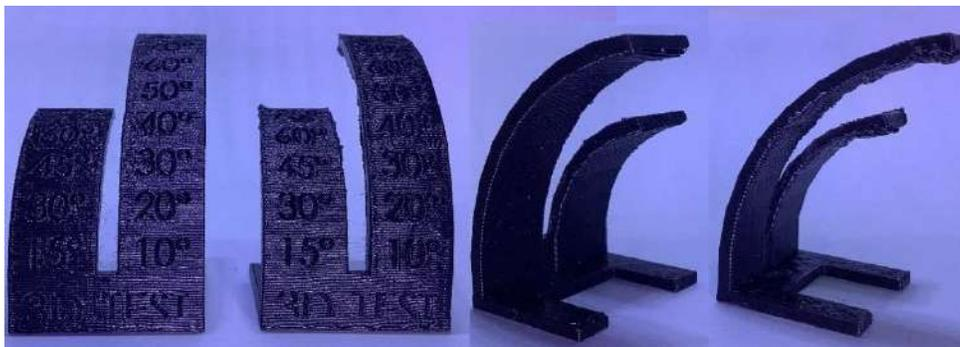
Fig. 171 Test ventilación PLA, Fuente propia.
