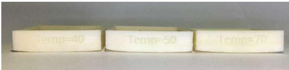
*Fig. 186 Temperatura ABS A8. Fuente propia.*
