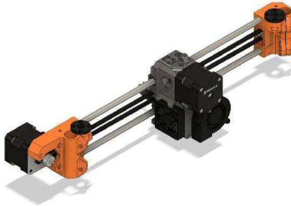
Fig. 38 Extrusor y eje X. Fuente:
