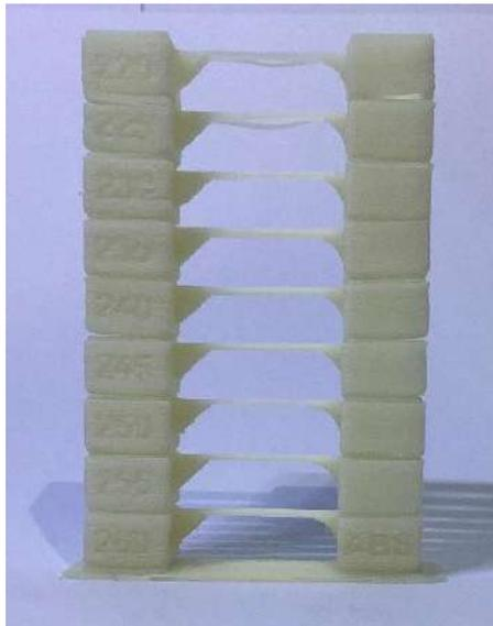
*Fig. 180 Test temperatura ABS A8. Fuente propia.*
