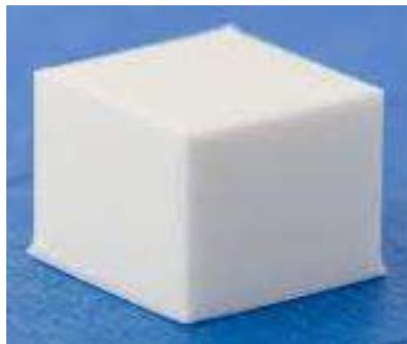
Fig. 55 Pie de elefante. Fuente: <https://capasobrecapa.com/solucionar-problemas-fdm/>
