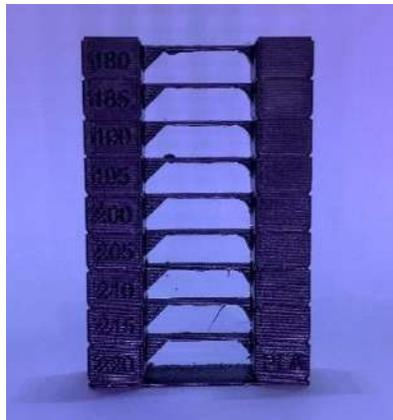
*Fig. 169 Test temperatura PLA. Fuente propia.*
