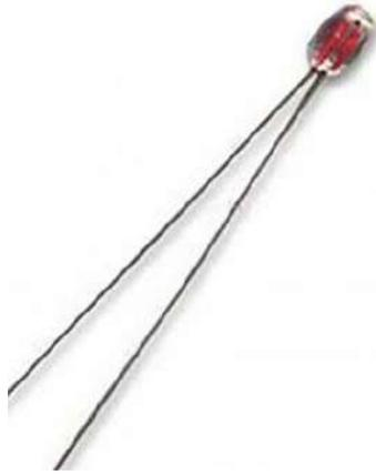
Fig. 66 Termistor. Fuente: [https://articulo.mercadolibre.com.ar/MLA-798211618-ntc-termistor-100k-impresora-3d-arduino-\\_JM](https://articulo.mercadolibre.com.ar/MLA-798211618-ntc-termistor-100k-impresora-3d-arduino-_JM)
