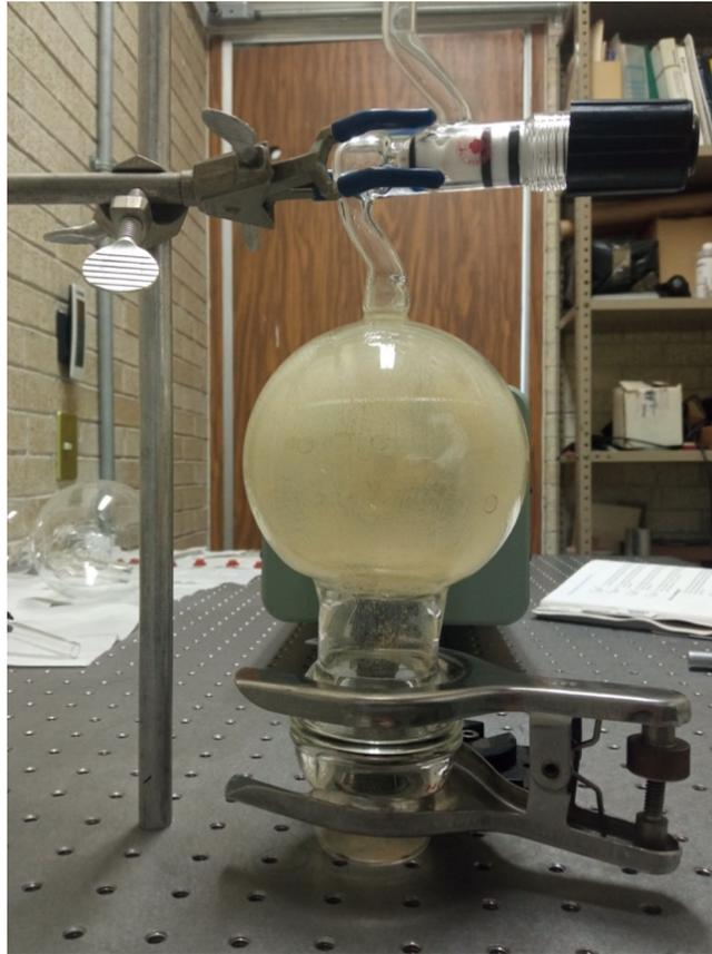
**Figura 5. 10.** Reactor diseñado para la extracción de aerosoles sin la utilización de disolventes.
