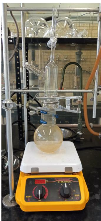
**Figura 5. 9.** Sistema implementado para la extracción de aerosoles utilizando metanol como disolvente.
