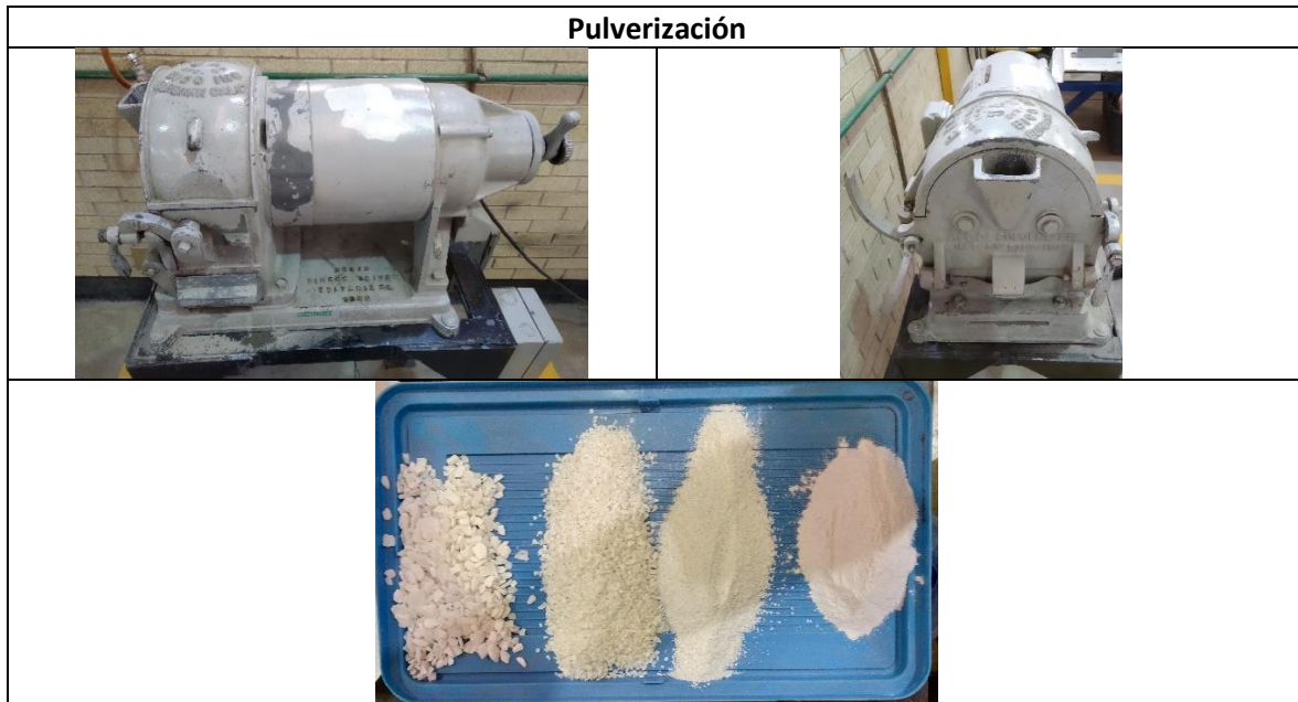
Figura 29. Proceso de Pulverización de la muestra de Barita.
