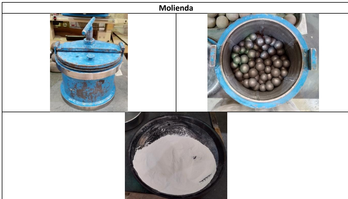
Figura 30. Proceso de Molienda de la muestra de Barita.
