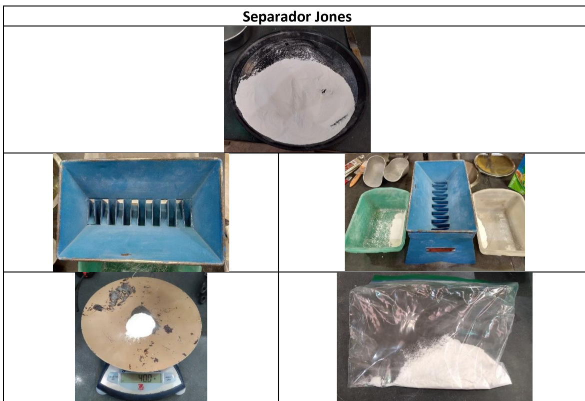
Figura 31. Proceso de Separación de muestras por el Separador Jones.
