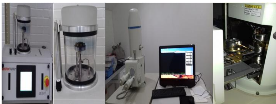
Fig. 2.15 Microscopia electrónica en un microscopio electrónico de barrido JEOL Modelo JSM-6010LA.
