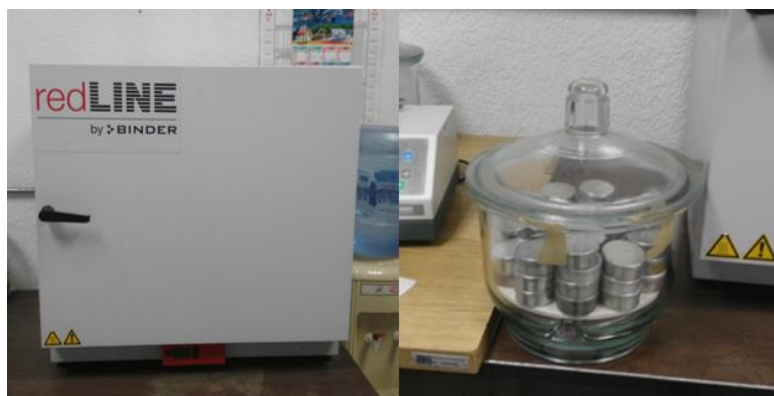
Fig. 2.1 Determinación de humedad en grano de maíz.
