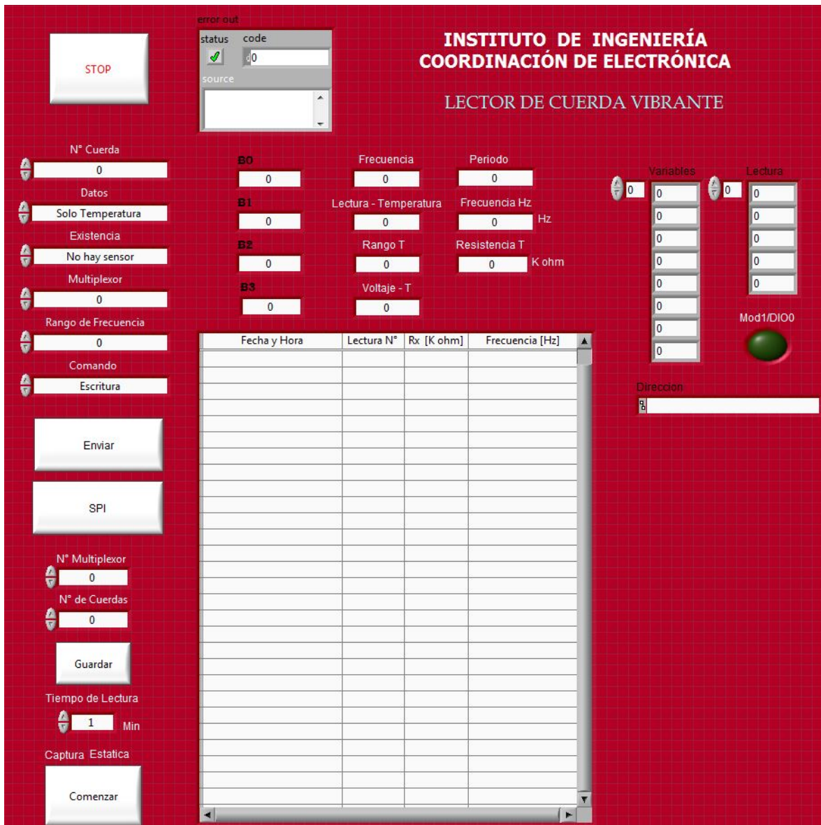
Figura 9. Programa en LabVIEW para el procesamiento de variables de sensores de cuerda vibrante.
