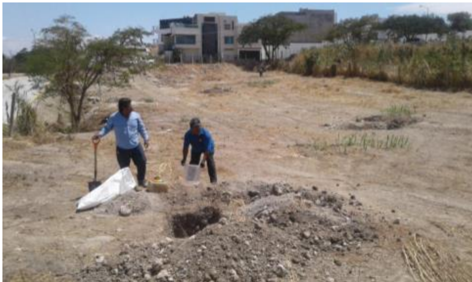
Recuperación de muestra alterada del subsuelo en el sondeo tipo pozo a cielo abierto (PCA- 04)
