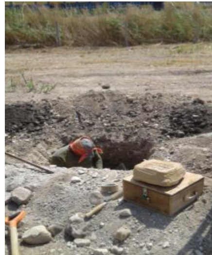
Recuperación de muestra inalterada del subsuelo en el sondeo tipo pozo a cielo abierto (PCA- 03)
