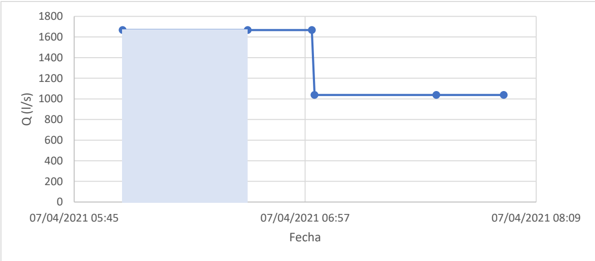
Figura 4.9. Gráfica de dos horas de caudal bombeado en PB Xotepingo
