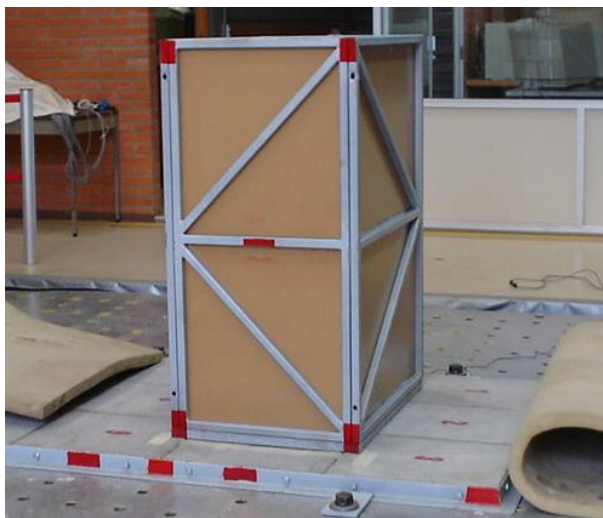
Figura 5.4. Ejemplo del sistema utilizado para estimar los giros y desplazamientos en cada prueba.
