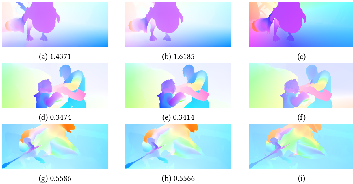
Figura 4.7: Estimación de flujo óptico y EPE en el conjunto Clean usando EAI: (a), (d) y (g); estimación usando RIC: (b), (e) y (h); ground truth : (c), (f) e (i).
