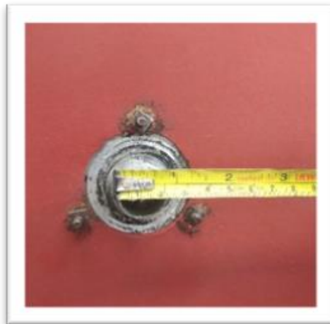
Imagen 7 Cuello del vertedero de la copa de vaciado de la máquina de fundición centrífuga
