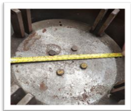
Imagen 10 Diámetro de la base rotatoria de la máquina de fundición centrífuga
