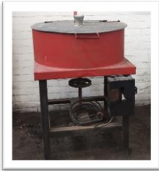
Imagen 4 Máquina de fundición centrífuga, vista frontal
