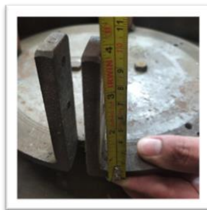
Imagen 11 Soporte para contrapesos y seguros de la máquina de fundición centrífuga
