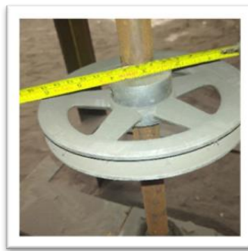
Imagen 13 Diámetro de la polea de transmisión de la máquina de fundición centrífuga
