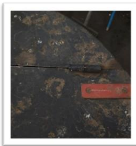
Imagen 8 Detalle de las bisagras de la tapa de la máquina de fundición centrífuga
