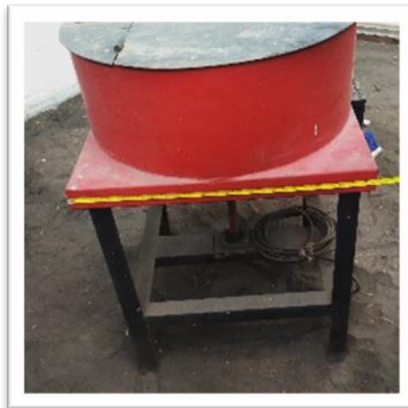
Imagen 1 Base estructural de la máquina de fundición centrífuga
