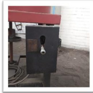
Imagen 18 Cajetín de encendido de la máquina centrífuga
