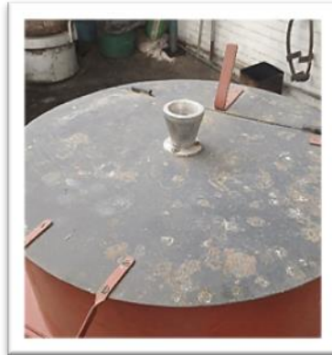
Imagen 15 Vertedero, ubicado en la tapa de la máquina de fundición centrífuga
