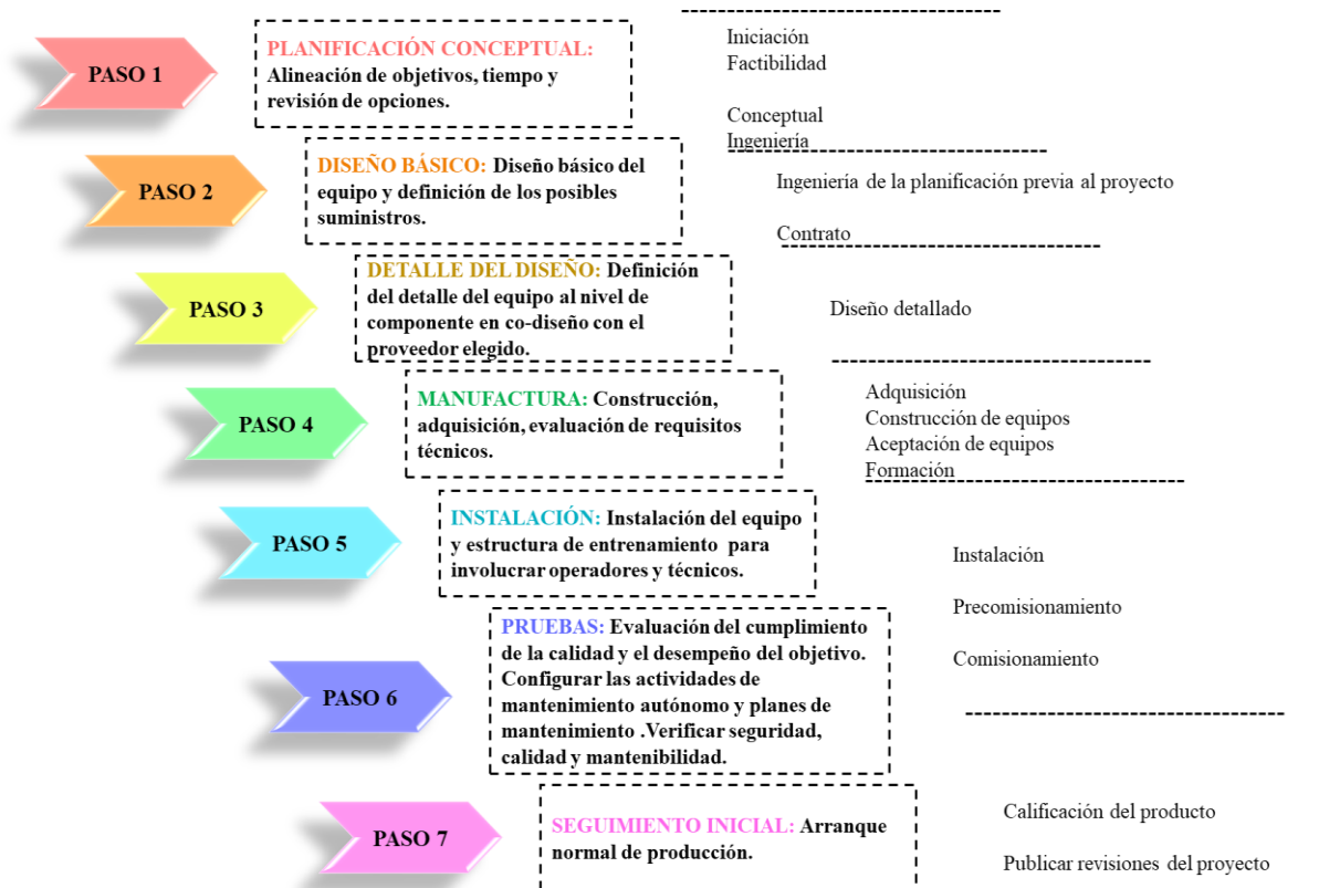
Ilustración 6 Los siete pasos del pilar de EEM. Fuente: Elaboración propia basada en presentación del profesor Yamashina "World Class Manufaturig".
