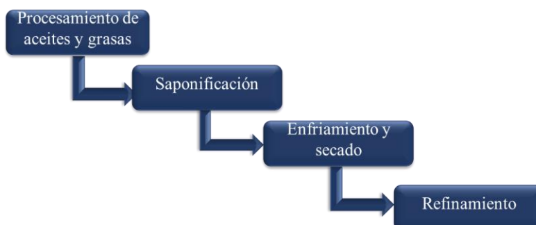
Ilustración 7 Manufactura del jabón en cuatro pasos
