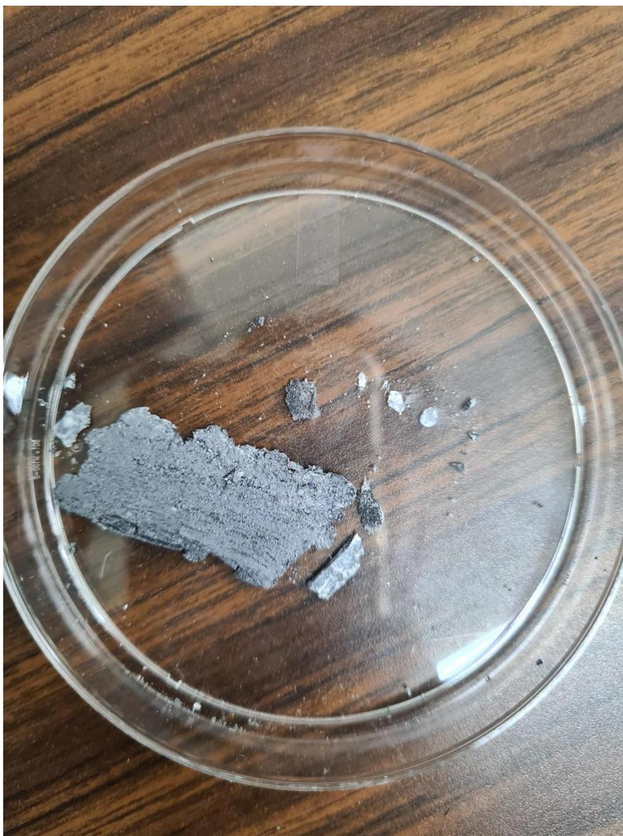
**Figura 20** Se muestra el deposito de plata el deposito de plata recuperado de la macroelectrólisis.
