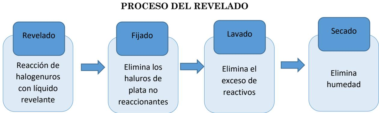
**Figura 2** Diagrama de bloques del proceso de revelado radiográfico, a través de sus distintas etapas y los principales procesos químicos que ocurren en cada una de ellas.
