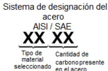
Figura 7. Representación esquemática de la designación de aceros AISI/SAE. [7]
