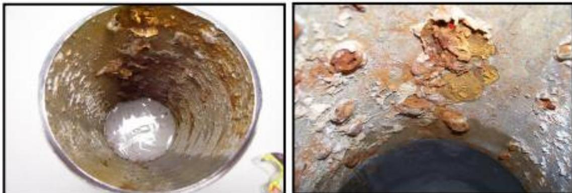
Figura 4. Efecto en muestras de cañerías afectadas por ácido sulfhídrico [4]
