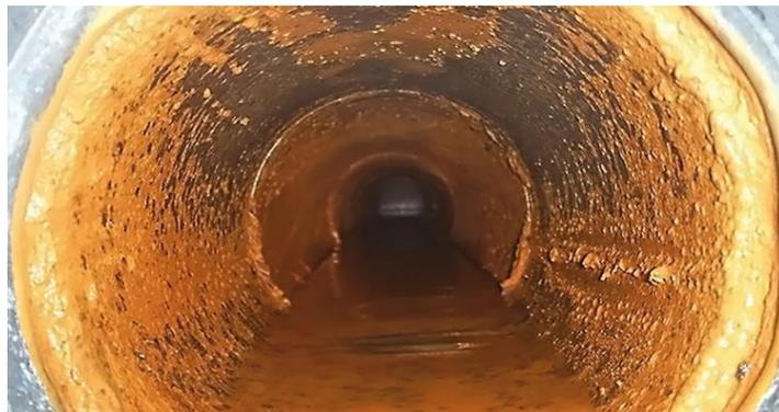
Figura 6. Efectos de la corrosión producidos en una tubería por acidificación (pH) y O<sub>2</sub> [6]
