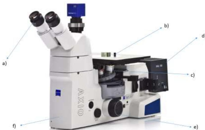
*Figura 5. Microscopio metalográfico binocular invertido, ZEISS Axio Vert.A1; a) Oculares, b) Platina o porta muestras, c) Sistema de objetivos, d) Sistema de iluminación, e) Perilla de enfoque, f) Soporte. [11]*
