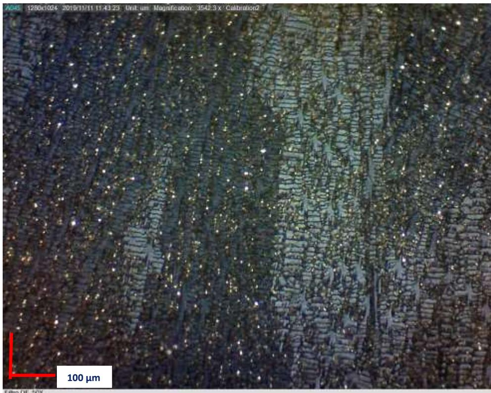
*Figura 20. Micrografía MO-DF 50x. Revelado químico de 15 minutos.*
