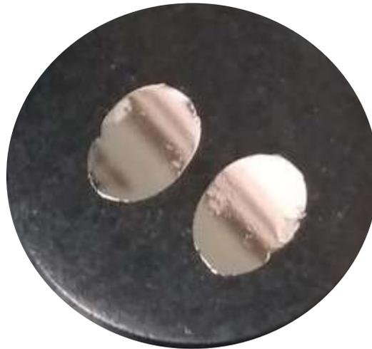
*Figura 15. Botón de aleación Cantor obtenido por Horno de arco eléctrico cortado a la mitad, montado en baquelita y pulido "a espejo".*
