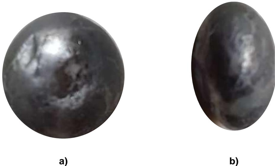
*Figura 17. Botón obtenido por síntesis con horno de arco eléctrico de aleación Cantor a) vista superior, b) vista lateral.*
