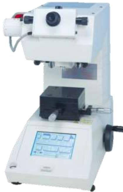
*Figura 10. Durómetro HMV-2 Shimidzu*
