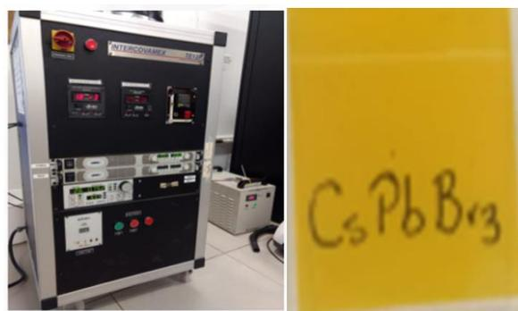
***Figura 9: película depositada por evaporación de polvo de cristales de CsPbBr<sub>3</sub> con aproximadamente 500 nm.***
