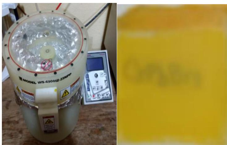
**Figura 6: Equipo utilizado para llevar a cabo el depósito de la película delgada de CsPbBr<sub>3</sub> por el método químico y una foto de película obtenido.**
