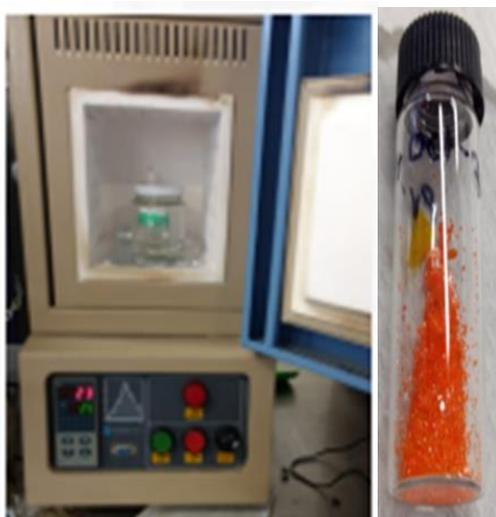
***Figura 7: Cristales de CsPbBr<sub>3</sub> crecidos a temperatura de 35°C/72h, aproximadamente 1gr.***
