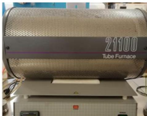
*Figura 10: Horno tubular horizontal, se utilizó para hacer tratamiento térmico de las películas depositadas de CsPbBr<sub>3</sub> de las tres técnicas.*
