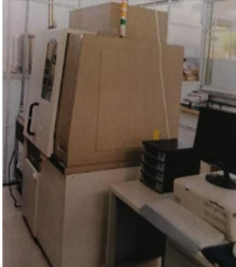
*Figura 15: Equipo de XRD RIGAKU DMAX-2200.*
