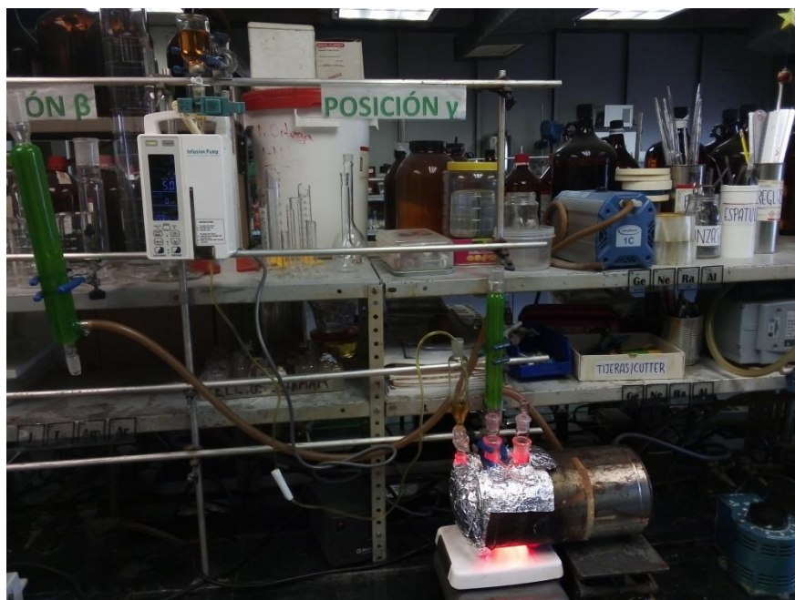
Figura 7.8. Montaje experimental para la síntesis de la 1^1H -2,3-diaza-1(5,2)-benzimidazolaciclododecafan-4-ona.
