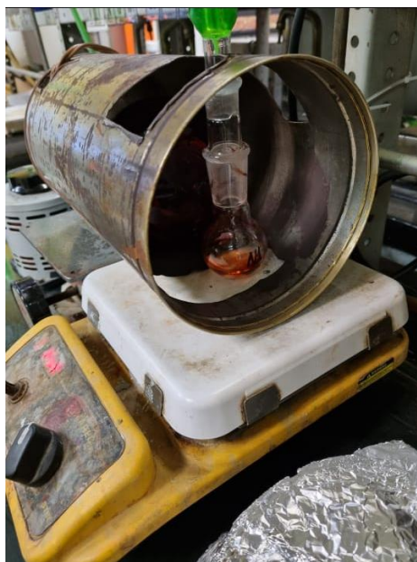
Figura 7.7. Montaje experimental para la síntesis del ácido 10-(2-(3-amino-4-nitrofenil)hidrazinil)-10-oxodecanoico.
