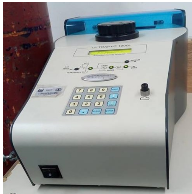
Figura 2.10. Picnómetro utilizado para la determinación del volumen de la espuma.
