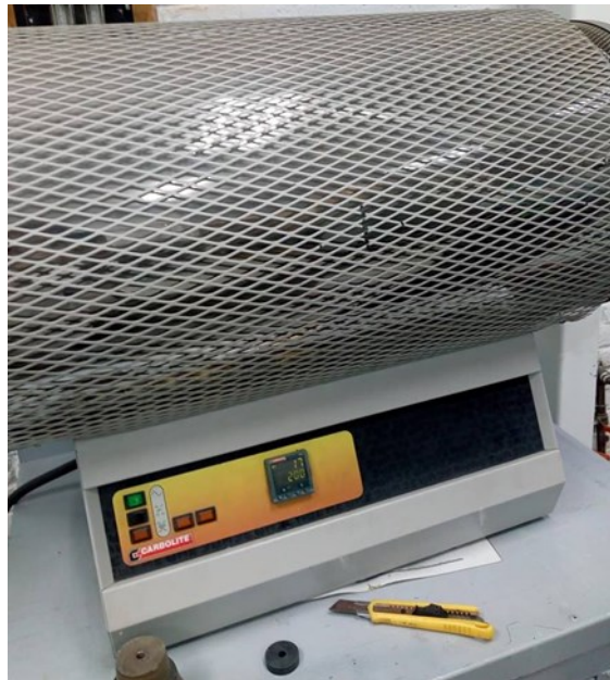
Figura 2.11. Horno tubular utilizado para el tratamiento de solubilización.
