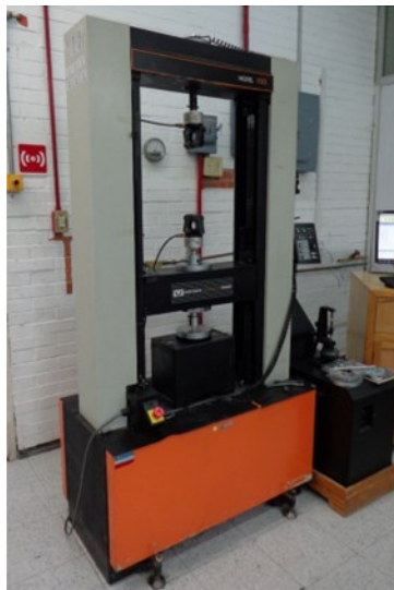
Figura 2.13. Máquina universal de pruebas mecánicas.
