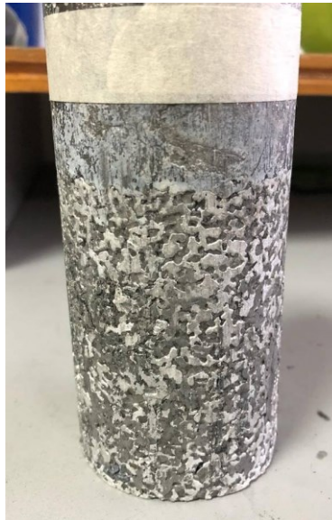
Figura 2.6. Espuma obtenida mediante el proceso de infiltración.
