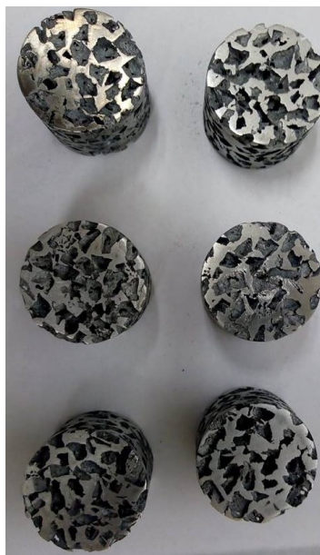
Figura 2.9. Probetas sin NaCl retiradas del ultrasonido
