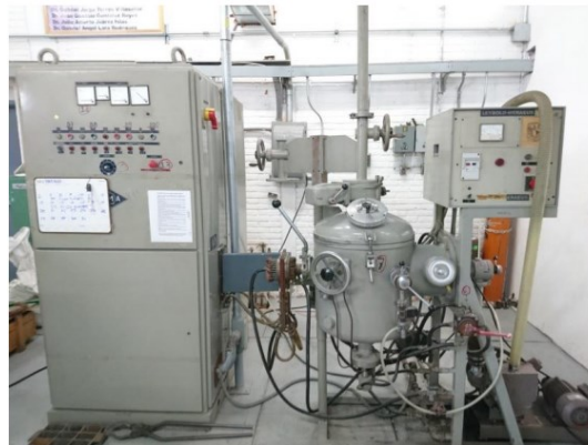
Figura 2.1. Horno de inducción de atmósfera controlada.
