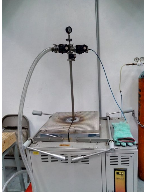
Figura 2.4. Reactor introducido al horno eléctrico, conectado al tanque de gas y a la bomba de vacío.
