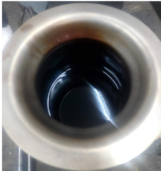
Figura 2.12. Crisol con aceite utilizado para el tratamiento de envejecimiento.
