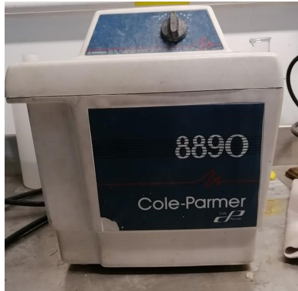
Figura 2.8. Ultrasonido utilizado para la eliminación del NaCl.
