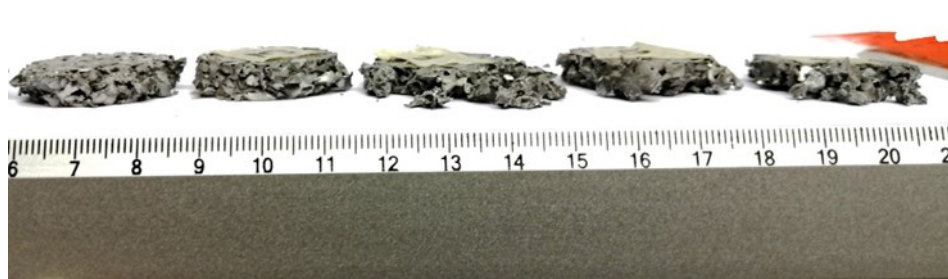
Figura 3.6. Vista lateral de las probetas después del ensayo de compresión.
