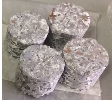
Figura 2.7. Probetas para compresión obtenidas del maquinado.
