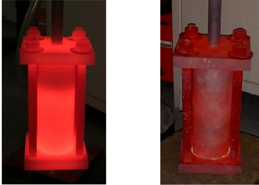
Figura 2.5. Reactor al momento de retirarlo del horno eléctrico.
