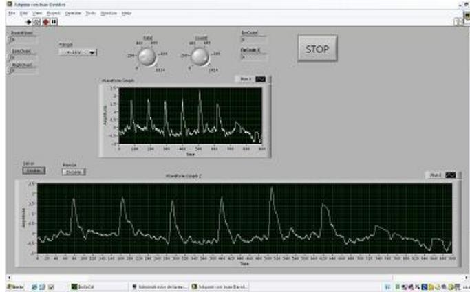
Fig. 46: Resultados de la señal de pulsioximetria en el programa de LabView.
