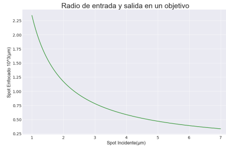
Figura 3.1: Relación de radios con un objetivo PLAN del fabricante THORLABS [49] con M = 40X , WD = 0.6mm , EFL = 4.5mm , NA = 0.65 y EP = 5.9mm
