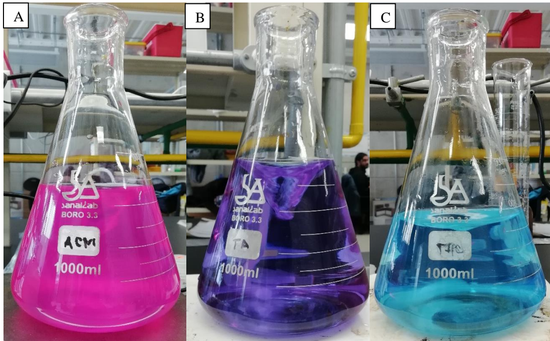
Figura 9. Medio de cultivo para aislamiento de BOA. (A) Medio de cultivo aerobio (MCA) con indicador rojo fenol; (B) Medio de cultivo Thiobacillus agar (TA) con azul de bromofenol; (C) Medio de cultivo Thiobacillus acidophilus agar (TAC) con verde de bromocresol.
